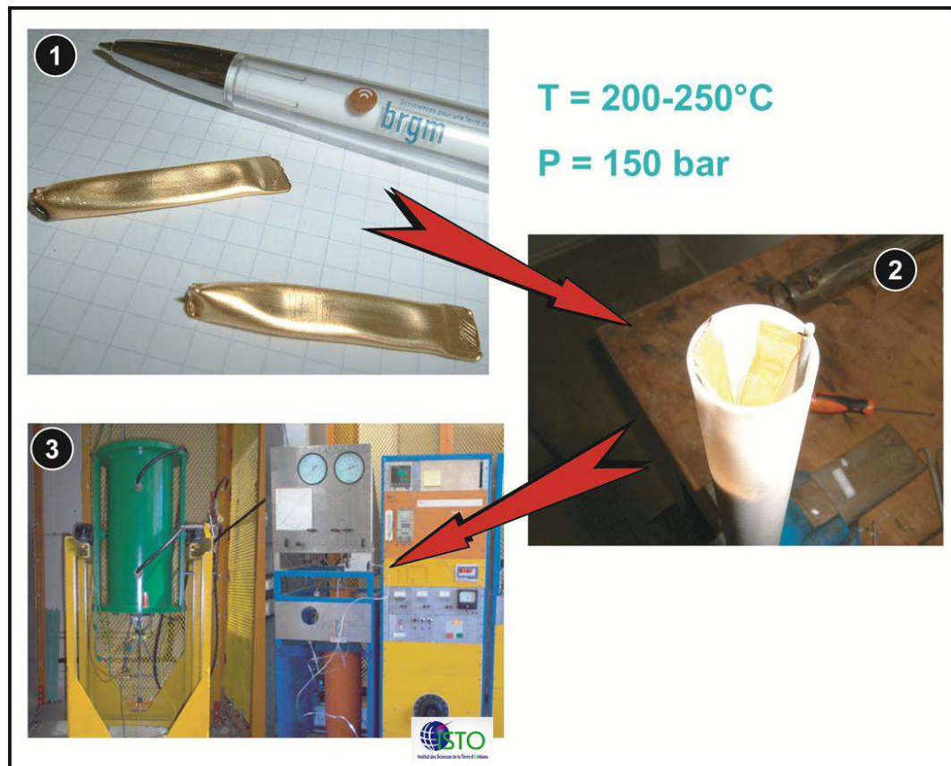
Figure 40 - Dispositif expérimental pour les interactions à 25°, 75° et 200°C (BRGM).
