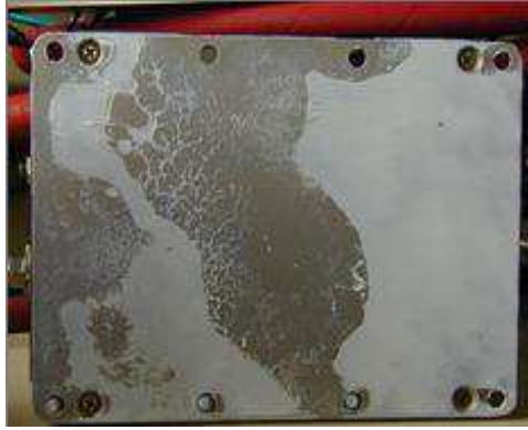
Figure I.18 : Défaut du 1 er ordre sur un module IGBT 1200A/33000V [COQ02].
