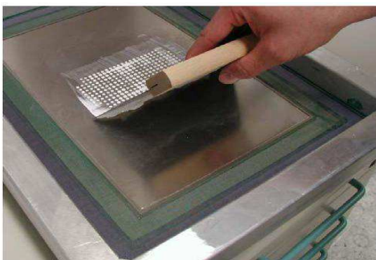
c) Application de la graisse thermique G641 sur le module à travers le pochoir.
