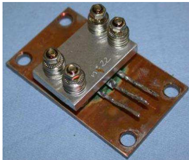
a) Véhicule test n°22 monté avec une interface à changement de phase.
