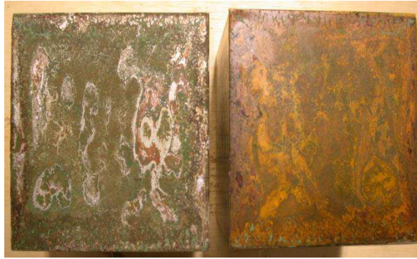
Figure I.27 : Eléments de l'interface à changement de phase Hiflow 300P (IFSTTAR-LTN).
