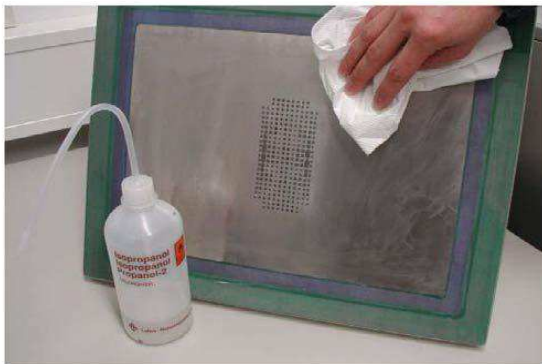
a) Nettoyage à l'alcool isopropylique du pochoir utilisé pour le dépôt de la graisse thermique G641.
