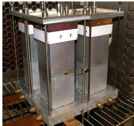
Figure II.14 : Positionnement des bancs dans l'enceinte climatique.
