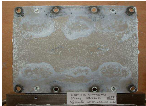
Figure I.25 : Illustration du phénomène de séchage sur un module IGBT Eupec type FZ1500R33HE3 après un cyclage haute température (INRETS-LTN).
