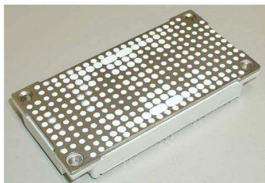
d) Résultat du dépôt de graisse thermique sur la semelle du module.
