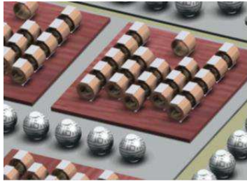
a) "Solder bumps" sphériques et cylindriques de type "pipe" [FOC10].
