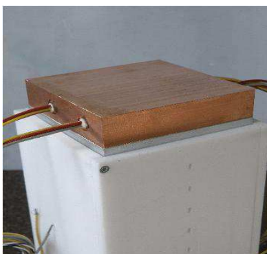
a) Montage expérimental de la source chaude.
