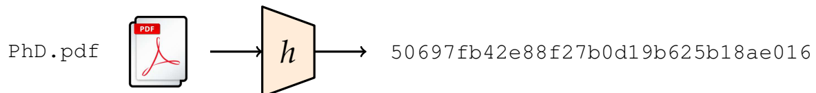
Figure 1.4: Fonction de hachage : la fonction h fournit une empreinte courte d'un document.
