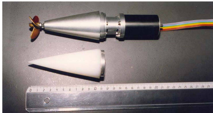
Figure 3 : Maquette d'essais : a) vues latérale et de face, b) parties terminales avec et sans propulseur.
