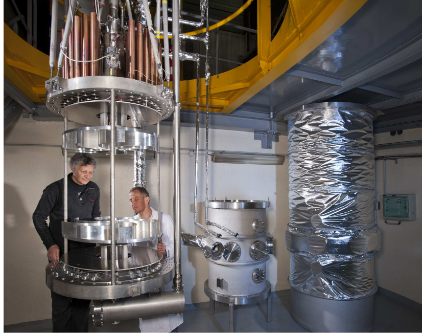
FIGURE 7.4 – L’intérieur du cylindre de l’expérience SHREK, avec deux des chercheurs, Bernard Rousset et Michel Bon-Mardion, qui entretiennent l’expérience au sein du SBT (à gauche). Nous pouvons voir la taille importante de l’expérience, ainsi que plusieurs des « curiosités » liées à l’utilisation d’hélium superfluide, notamment les renvois de transmission visibles sous la turbine du bas et les doigts en cuivre visibles au-dessus de la turbine du haut. Le cylindre fermant l’écoulement est visible à l’arrière-plan au centre, tandis que la cuve contenant le bain d’hélium liquide et assurant l’isolation thermique est visible à droite, entourée d’isolant multi-couches. Crédits photographiques : Artechnique Photographie, tous droits réservés.
