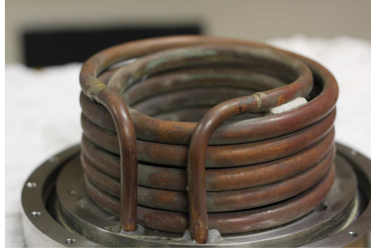
FIGURE 2.5 – Radiateur de l'expérience VK2, collé sur le couvercle métallique du haut.
