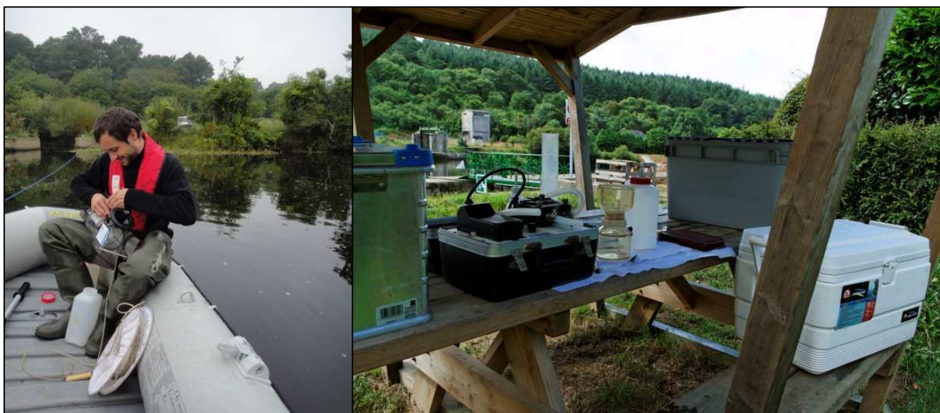
Fig. 2.3 Photos illustrant la préparation de la bouteille fermante pour le prélèvement d'eau (photo de gauche), et l'ensemble de dispositif de filtration (photo de droite).
