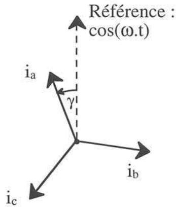
Figure III-1 : courants triphasés représentés dans le plan de Fresnel
