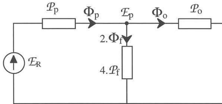
Figure II-23 : modèle équivalent au rotor et à vide
