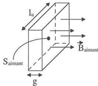
Figure II-28 : calcul de la perméance de l'aimant
