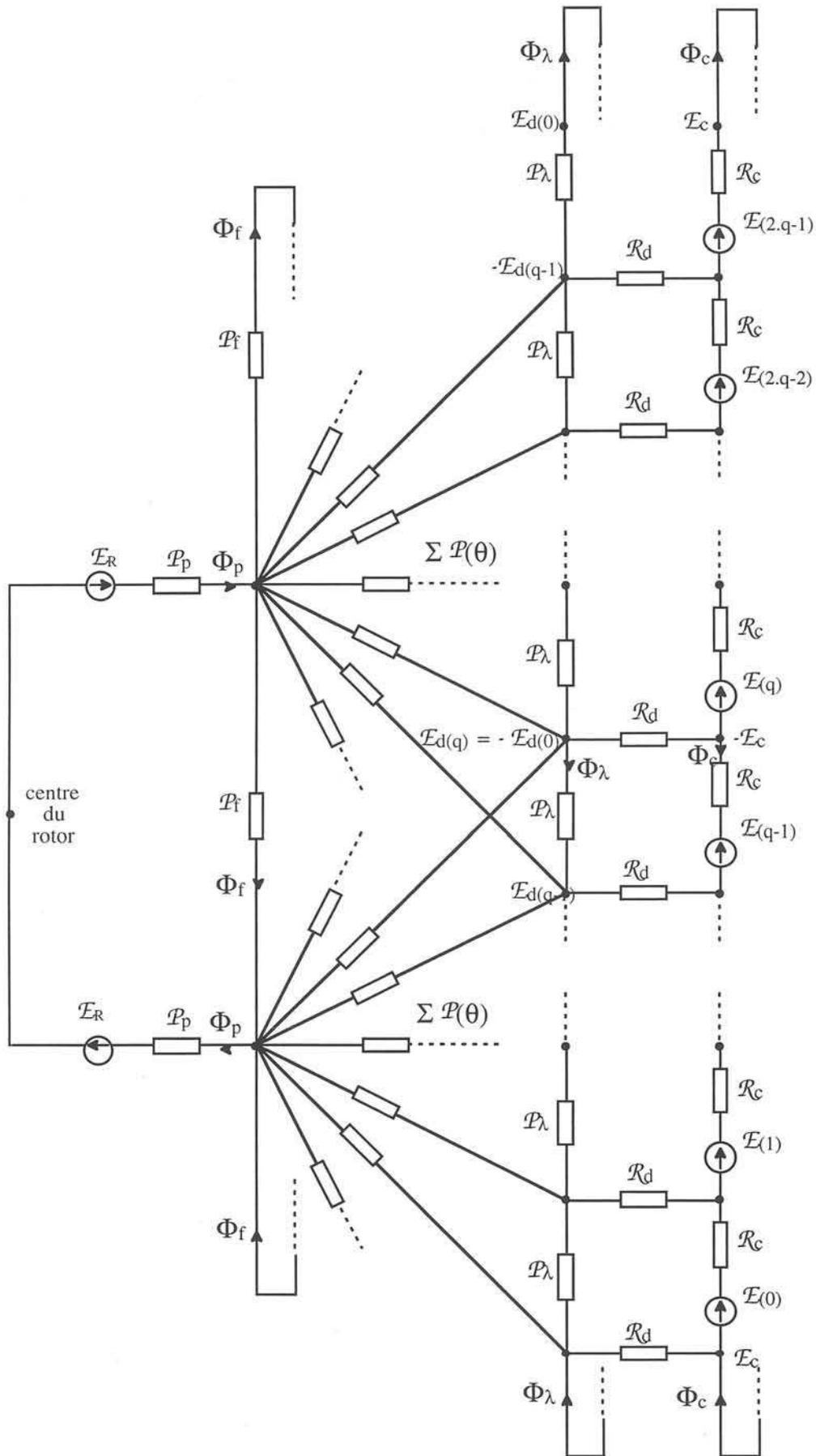
Figure IV-2 : modèle complet de la machine
