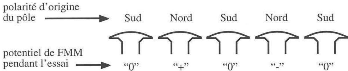
Figure II-7 : potentiel de FMM pendant l'essai
