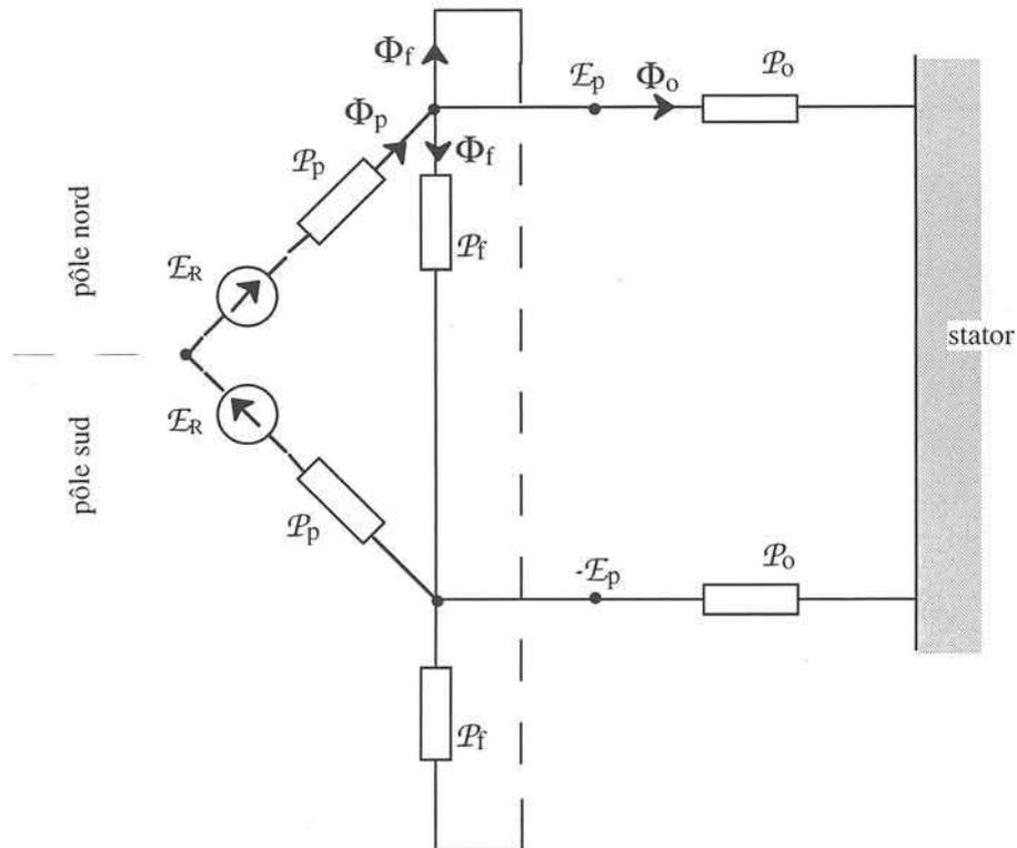
Figure II-22 : schéma équivalent d'une paire de pôle au rotor
