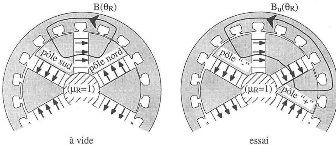
Figure II-33 : chemin suivi par la ligne d'induction principale
