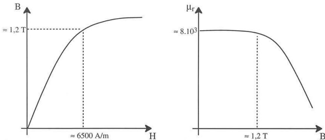
Figure IV-11 : courbe d'aimantation et perméabilité relative des tôles
