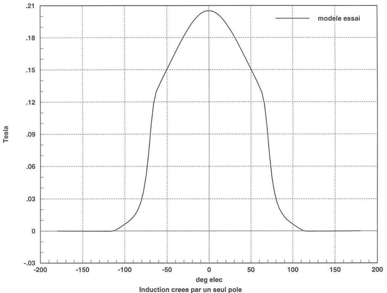
Figure II-12 : distribution de l'induction  $B_u(\theta)$  lorsqu'un seul pôle est alimenté
