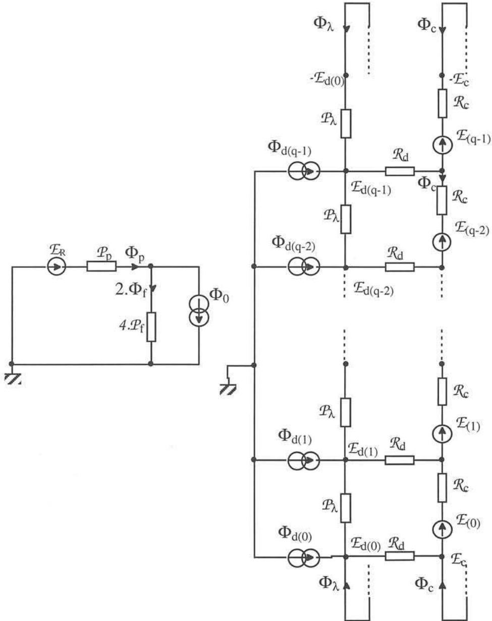
Figure IV-4 : schéma simplifié pour l'étude en charge
