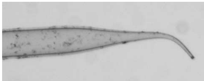
FIGURE 4.17 – Pointe de maglevtube avec extrémité coudée et amaïncie.
