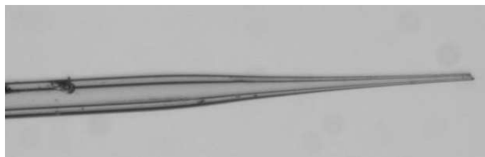
FIGURE 4.10 – Pointe de maglevtube avec extrémité amincie.
