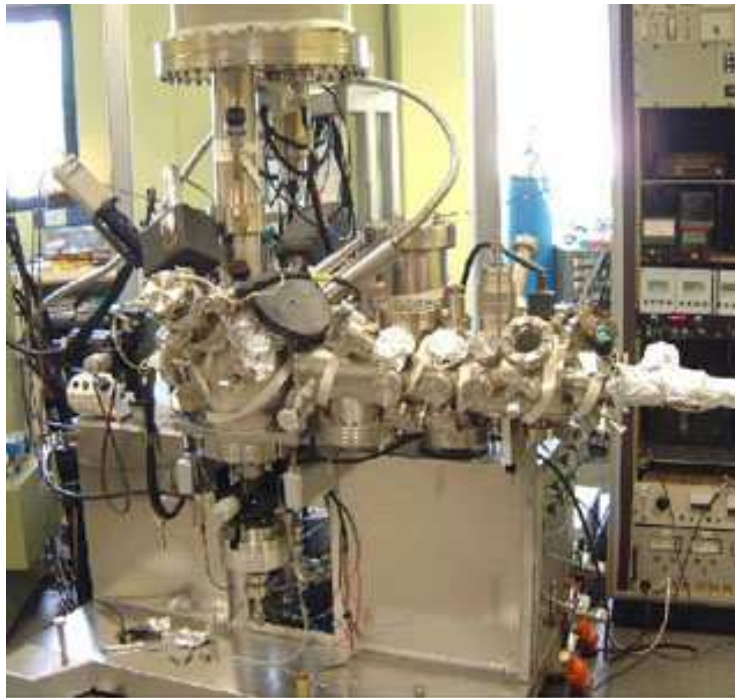
FIGURE 1.2 – Nanotribomètre analytique sous ultra-vide + analyses XPS.
