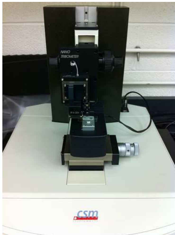
FIGURE 1.17 – Nanotribomètre commercialisé par CSM Instruments.
