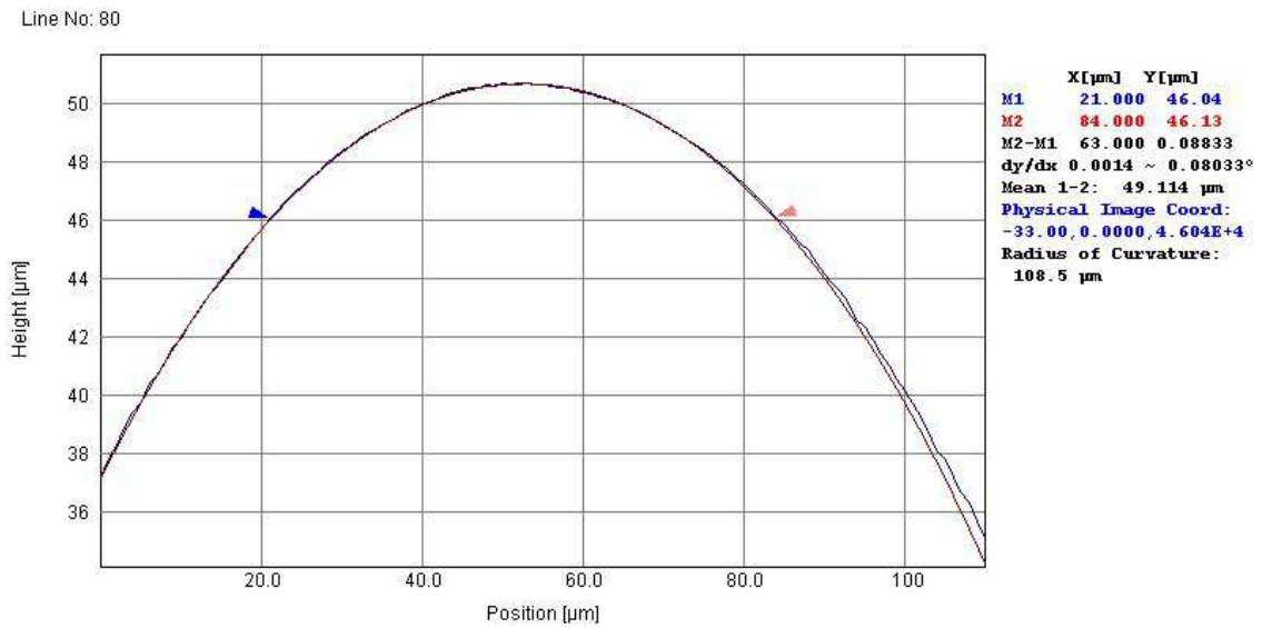
FIGURE 4.16 – Rayon de courbure d'une pointe sphérique obtenue avec le tour - Echantillon 2 : 108.5\mu\text{m}
