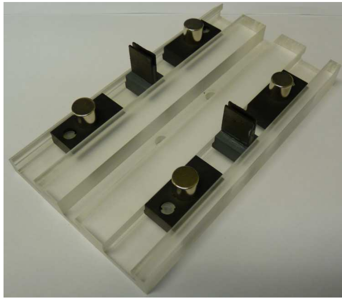
FIGURE 4.22 – Élément berceau de la version pré-industrielle du dispositif de mesure de micro et nanoforce.
