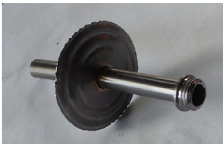
FIGURE VI.19 – Soufflet ajouté au tube transfert pour obtenir de la souplesse.
