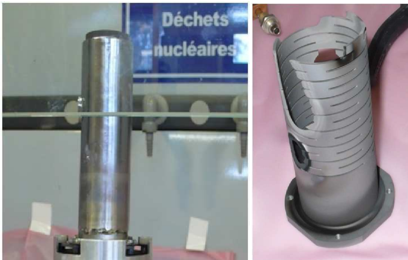
FIGURE VI.9 – A gauche : déformation du container cible due aux contraintes thermiques lors du premier test en mai ; à droite : évaporation du four en contact avec le container cible lors du conditionnement de la source pendant les tests de juillet 2011.
