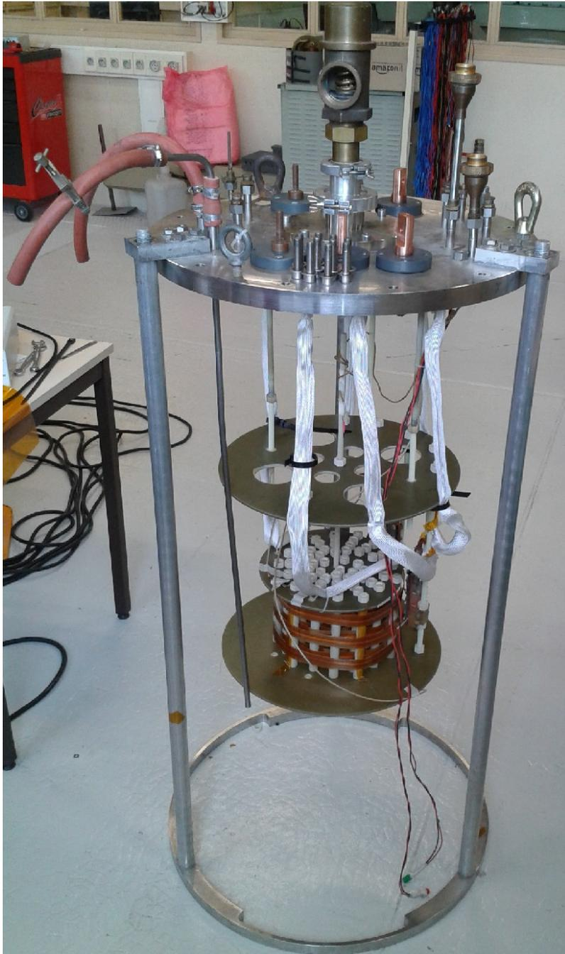
FIGURE IV.11 – Le limiteur de courant fixé sur la bride du cryostat
