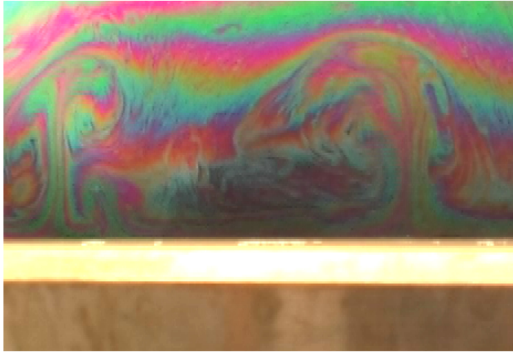
FIG. 3.4: photographie de la convection à l'équateur de la demi bulle de savon
