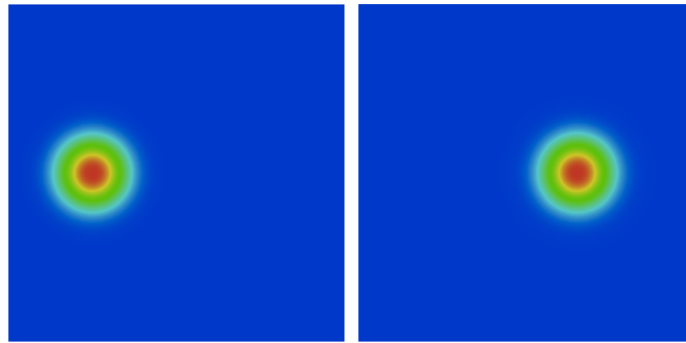
Figure 7.3: Gaussienne initiale à gauche et après 8 secondes de calcul à droite (maillage 141x141).
