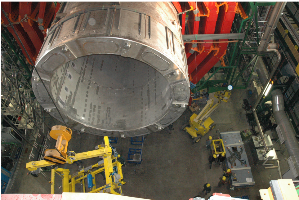
FIGURE 2.18 – Photographie de l’aimant solénoïdal de CMS inséré dans la roue centrale du fer pour le retour de champ magnétique. ©CERN
