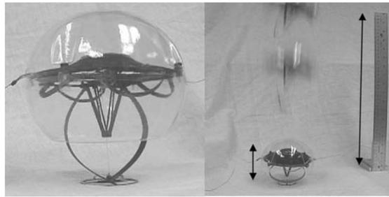
FIGURE 2.13 – Prototype de robot sauteur possédant un actionneur binaire permettant de charger un ressort de puissance pour exploration planétaire [81].
