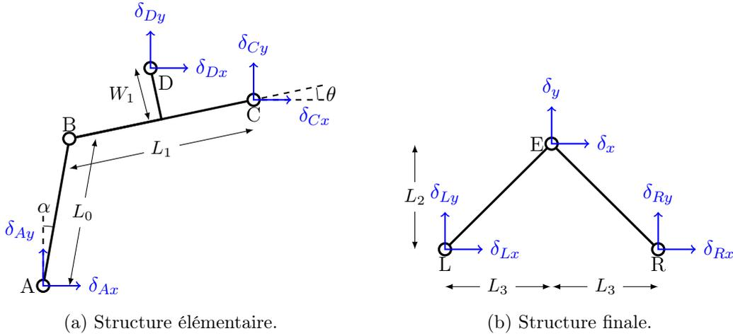
FIGURE 3.3 – Schéma cinématique de la structure élémentaire (a), et de la structure finale (b) constituant le microrobot numérique.
