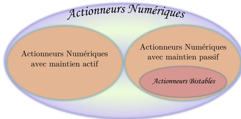
FIGURE 2.4 – Classification de différents types d'actionneurs binaires.
