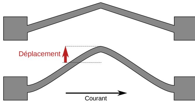
FIGURE 2.20 – Concept d'actionneur thermique de type V-beam.
