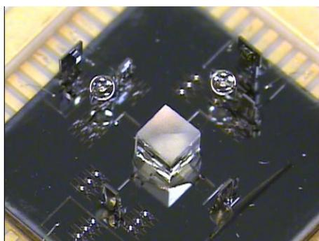
(a) Microspectromètre assemblé [26].
