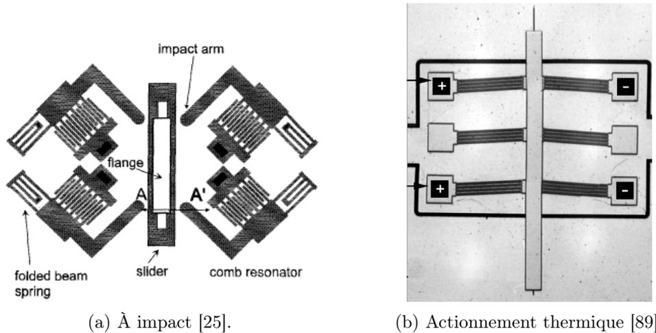
FIGURE 1.8 – Convoyeurs micrométriques.
