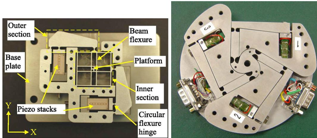
FIGURE 4.2 – Exemples de plateformes de micropositionnement planaire utilisant des actionneurs piézoélectriques et une structure flexible constituée d'articulations circulaires, fabriquées par usinage traditionnel [106, 107].
