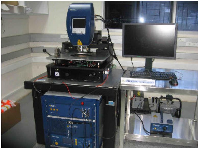
FIGURE 5.11 – MEMS Analyzer MSA-500 de la société Polytec.
