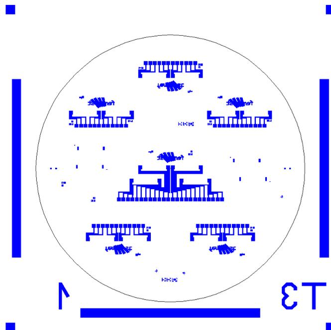
FIGURE B.1 – Masque A : connexions électriques.
