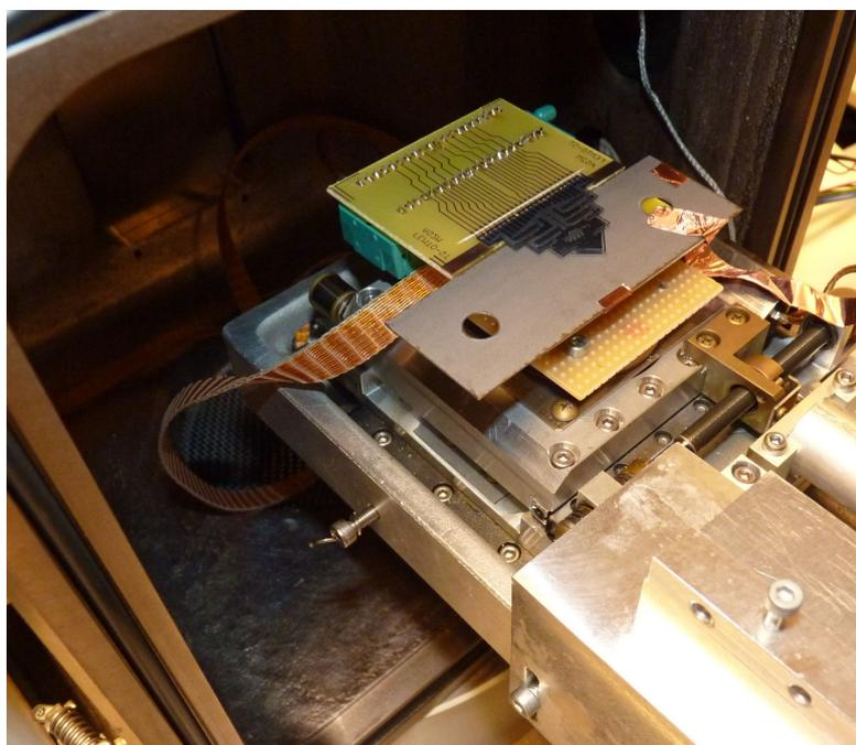
FIGURE 5.14 – DiMiBot connecté à l'intérieur d'un MEB.
