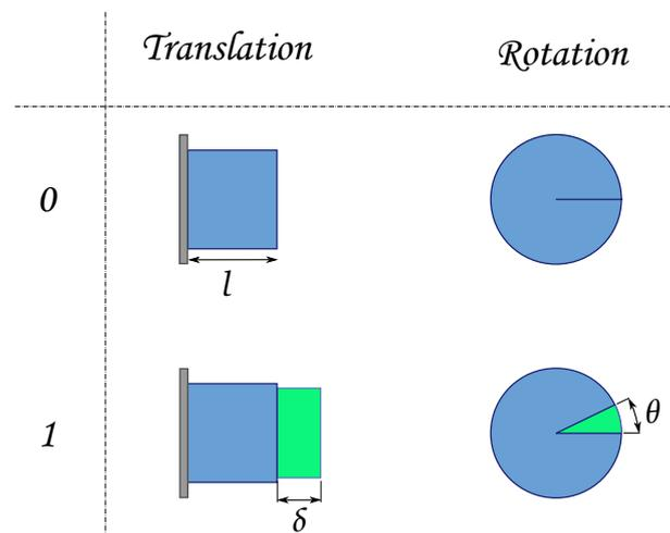
FIGURE 2.1 – Représentation schématique d'actionneurs binaires de type prismatique à gauche et rotoïde à droite dans les états 0 et 1.
