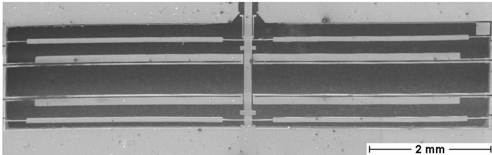
FIGURE 4.4 – Image MEB d'un module bistable.
