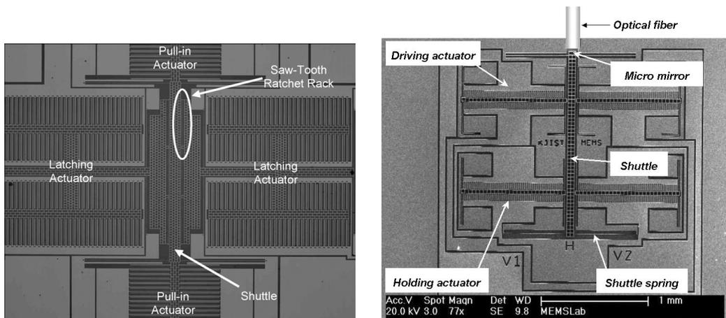
FIGURE 1.5 – Exemples de microrobots de type inchworm, microfabriqués de manière monolithique.
