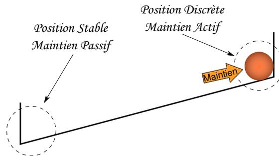
FIGURE 2.6 – Différence entre position à maintien actif et une position à maintien passif.
