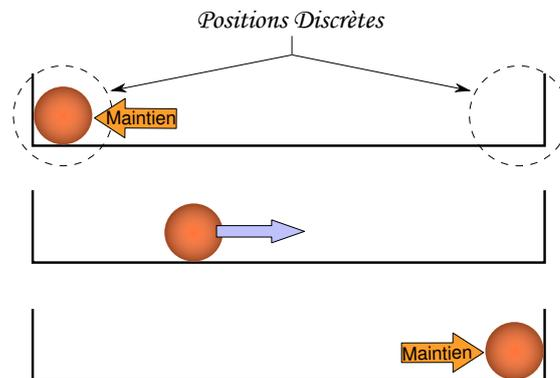
FIGURE 2.7 – Concept d'actionneur à maintien actif.
