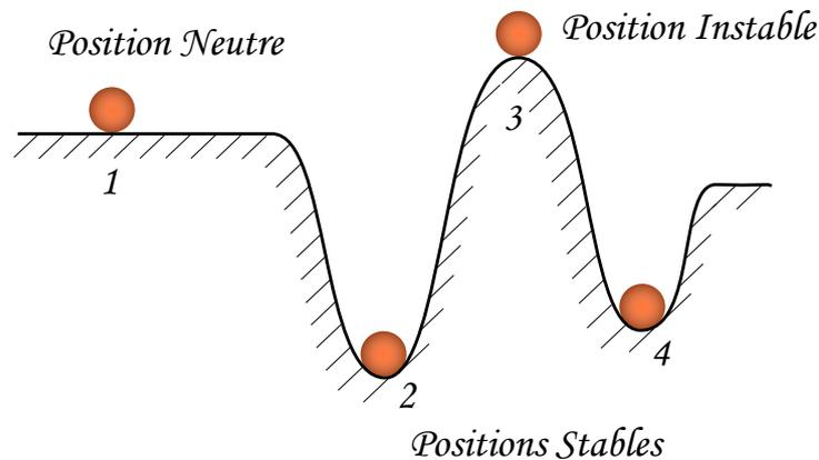
FIGURE 2.5 – Représentation schématique de la notion de stabilité d'un système.
