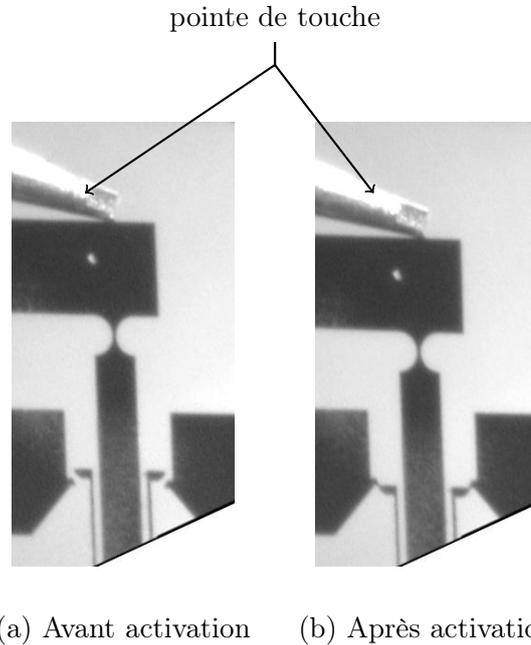
FIGURE 5.9 – Photo de l’activation manuelle d’un module bistable du microrobot.
