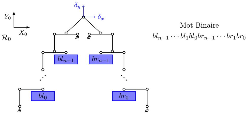
FIGURE 6.2 – Schéma cinématique de la structure robotique.
