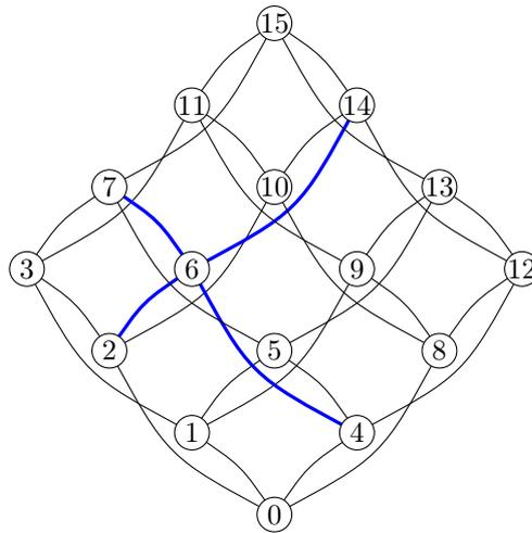
FIGURE 6.4 – Graphe d'un DiMiBot symétrique possédant 4 modules bistables.
