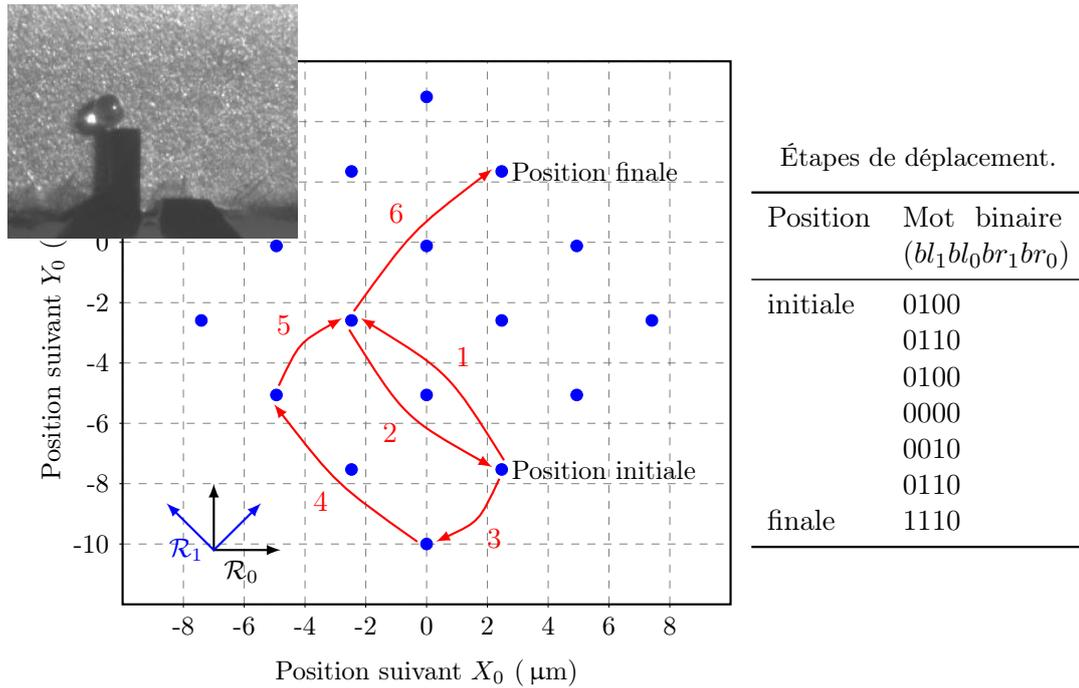
FIGURE 5.15 – Déplacement d'une microbille de  $150\ \mu\text{m}$  de diamètre.
