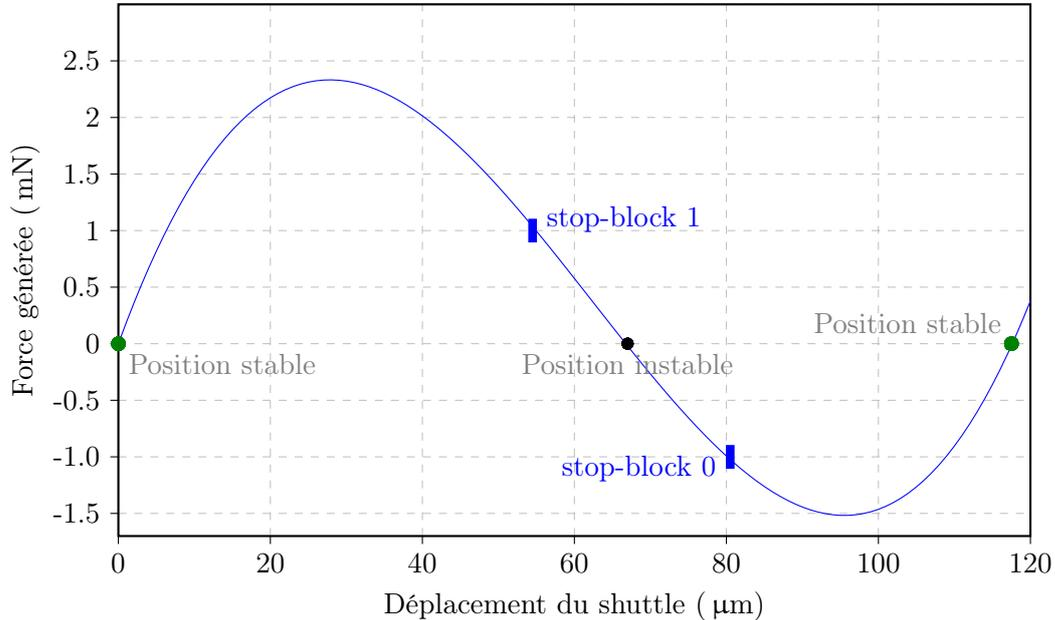
FIGURE 4.6 – Relation force/déplacement de la structure bistable, et positionnement des stop-blocks pour obtenir un déplacement  $\Delta = 25\ \mu\text{m}$  et des forces de blocage de  $1\ \text{mN}$ .
