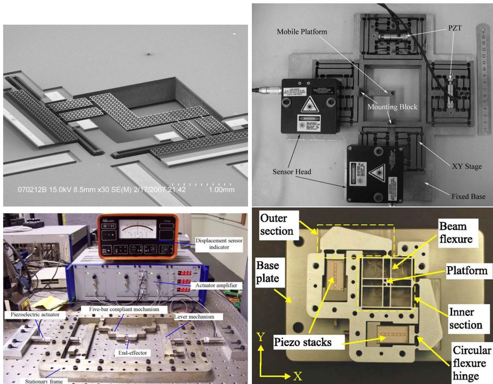
FIGURE 1.12 – Plateforme de micropositionnement 2 ddl.
