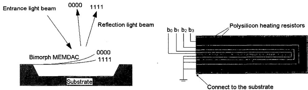
FIGURE 2.28 – Le MEMDAC bimorphe à actionnement thermique [68] utilisé comme miroir orientable.
