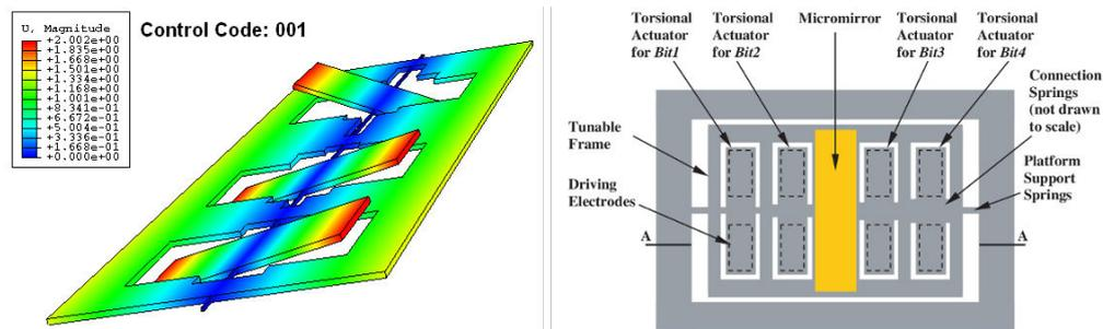
FIGURE 2.29 – DAC de torsion [111] à actionnement électrostatique.
