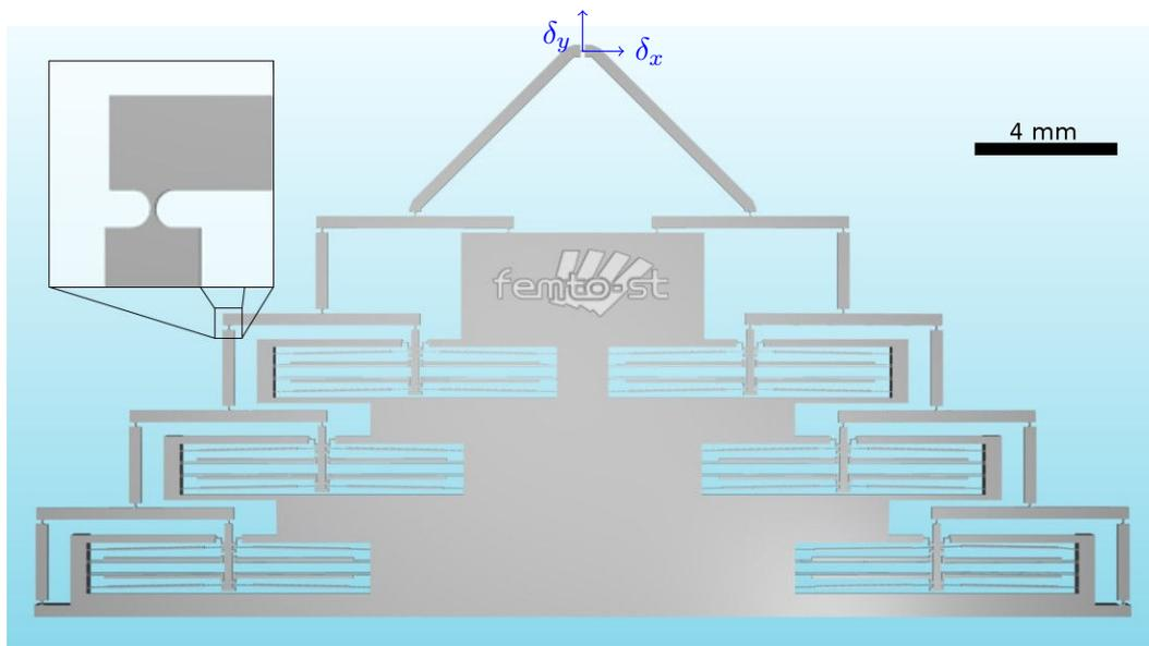
FIGURE 4.3 – Visualisation CAO d'un DiMiBot à 6 modules bistables.
