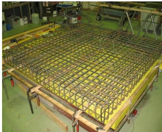
Figure 4-45. Ferrailage dans la dalle en béton armé
