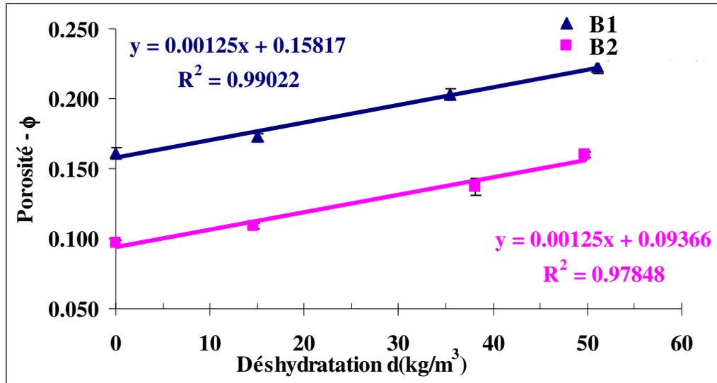
figure IV-4 : Équation expérimentale de l'évolution de la porosité en fonction de la déshydratation des bétons B1 et B2
