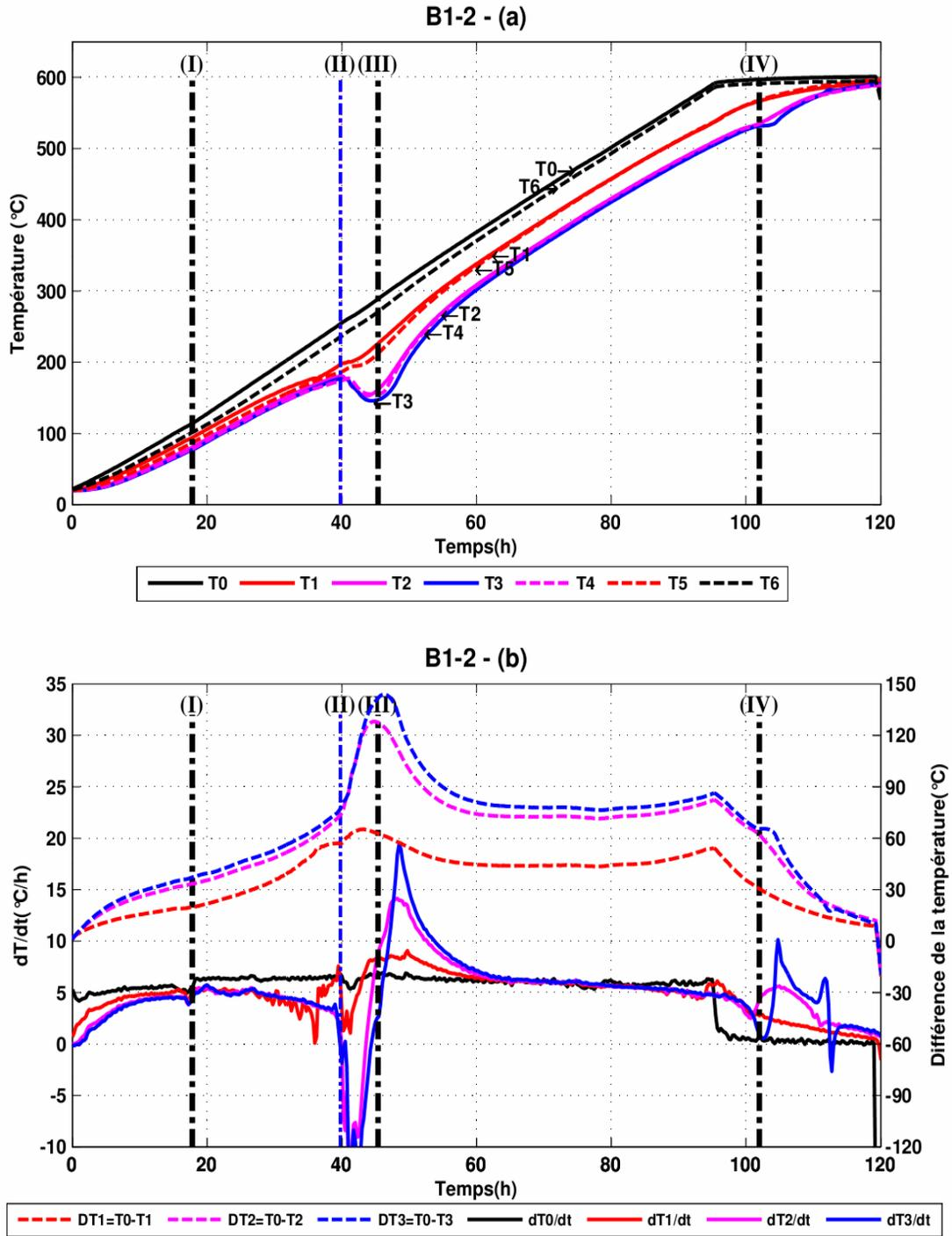
**figure III-18 :** Températures locales et de surface (a) et Dérivée temporelle de température ( $dT/dt$ ) et différences de température entre la surface et les points intérieurs, mesurées sur l'éprouvette de béton B1-2 en fonction du temps (b)
