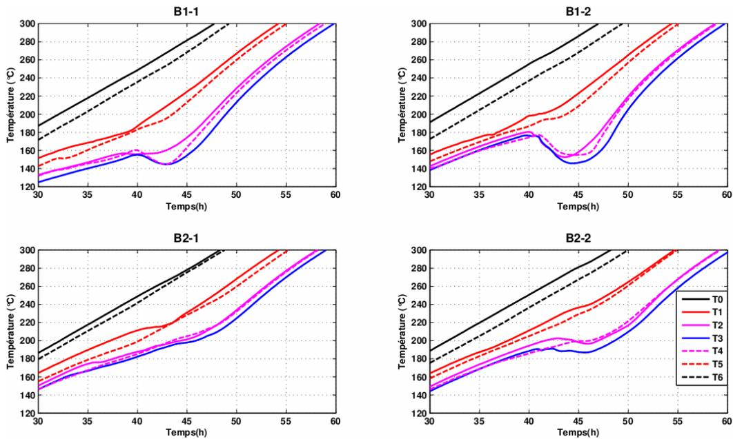
figure III-21 : Agrandissement du 1<sup>er</sup> palier de température des bétons B1 et B2
