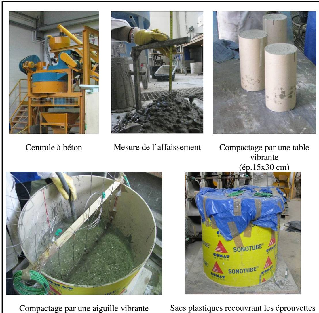
**figure II-4 : Confection des éprouvettes de béton**
