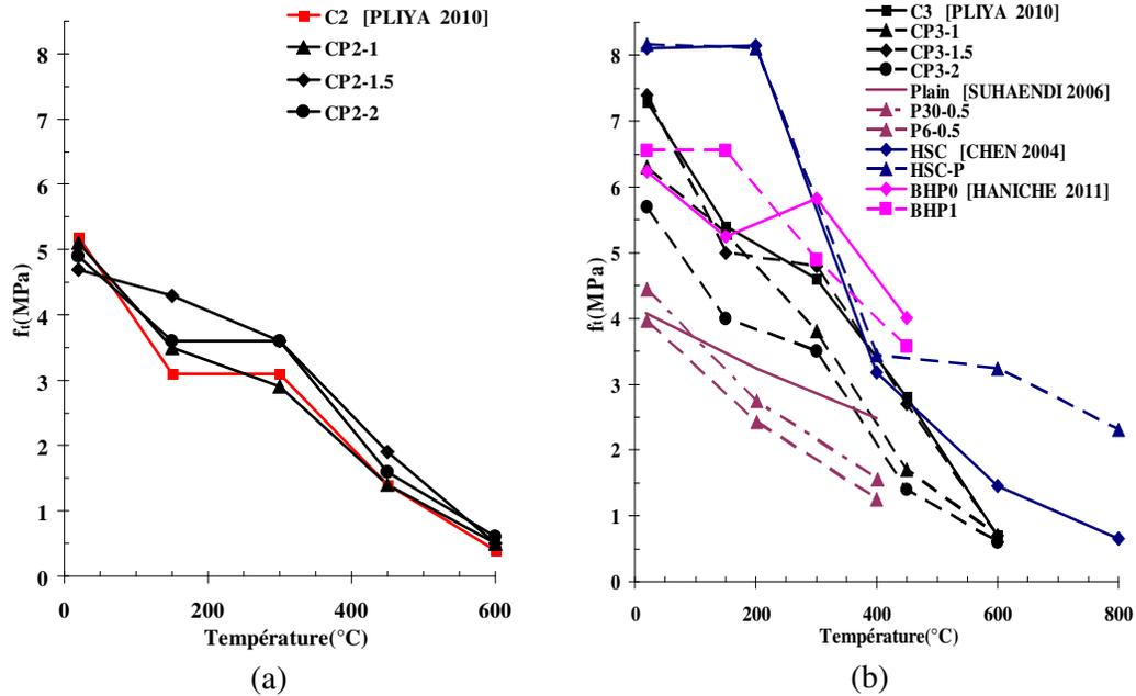
**figure I-21 :** Évolution de la résistance résiduelle à la traction par flexion de bétons avec et sans fibres de polypropylène : (a) pour BO et (b) pour BHP [Haniche 2011, Pliya 2010, Suhaendi et al. 2006, Chen et al. 2004]
