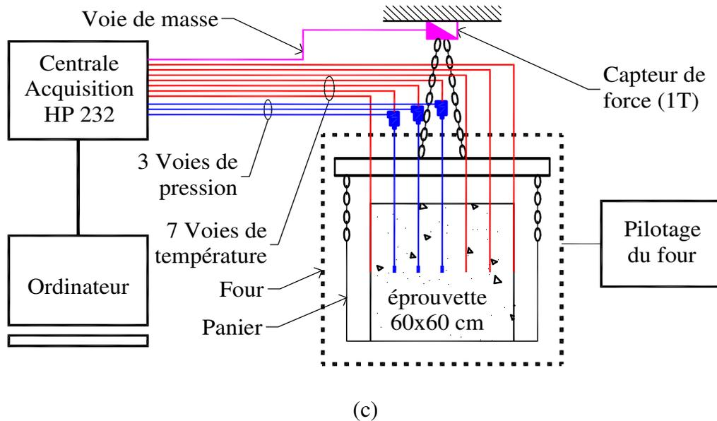
**figure II-6 :** Régulateur EURO THERM : Centrale d'acquisition automatique et enregistrement de données (a); Éprouvette placée dans le four (b); Schéma du dispositif d'acquisition de mesures de température, pression et perte de masse (c)
