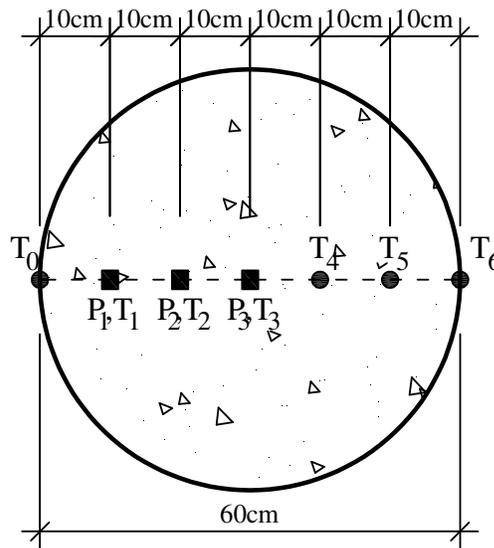
**figure III-16** : Schéma d'implantation des jauges et des thermocouples
