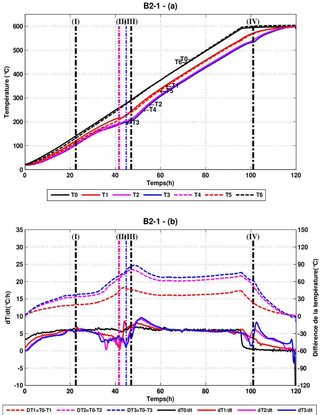
**figure III-19 :** Températures locales et de surface (a) et Dérivée temporelle de température ( $dT/dt$ ) et différences de température entre la surface et les points intérieurs, mesurées sur l'éprouvette de béton B2-1 en fonction du temps (b)
