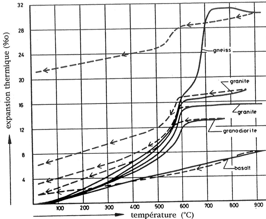
figure I-6 : Expansion thermique des granulats [Diederichs et al. 1989]
