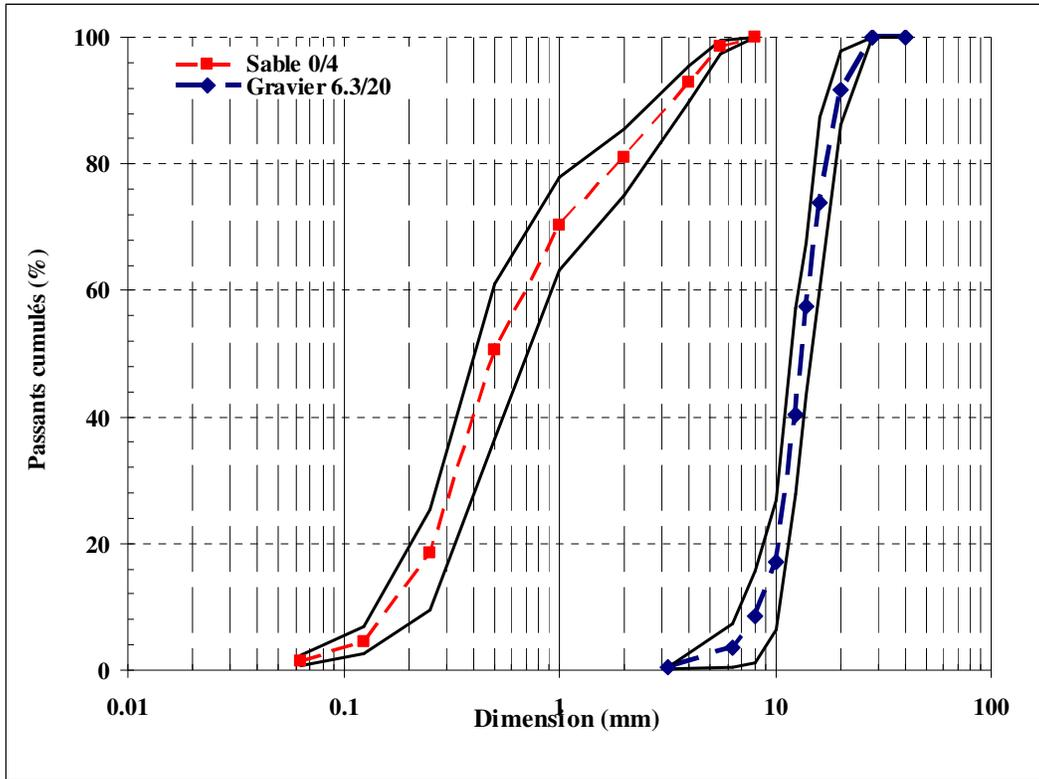
figure II-1 : Courbe granulométrique du sable 0/4 et du gravier 6.3/20
