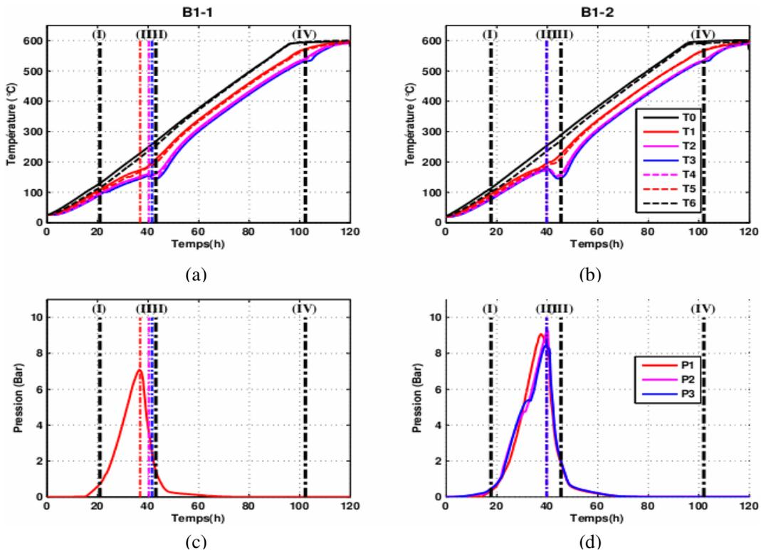
figure III-27 : Évolution de la température (a,b) et de la pression (c,d) dans le béton ordinaire (B1-1 et B1-2) en fonction du temps
