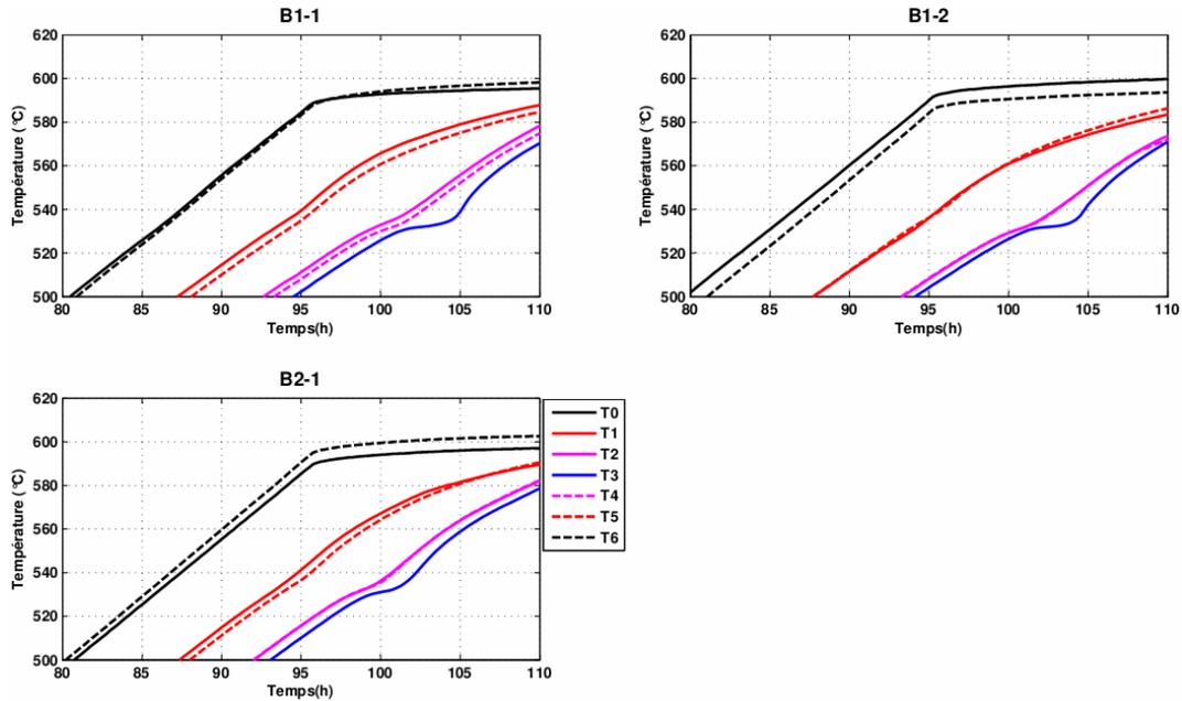
figure III-22 : Agrandissement du 2<sup>nd</sup> palier de température des bétons B1 et B2
