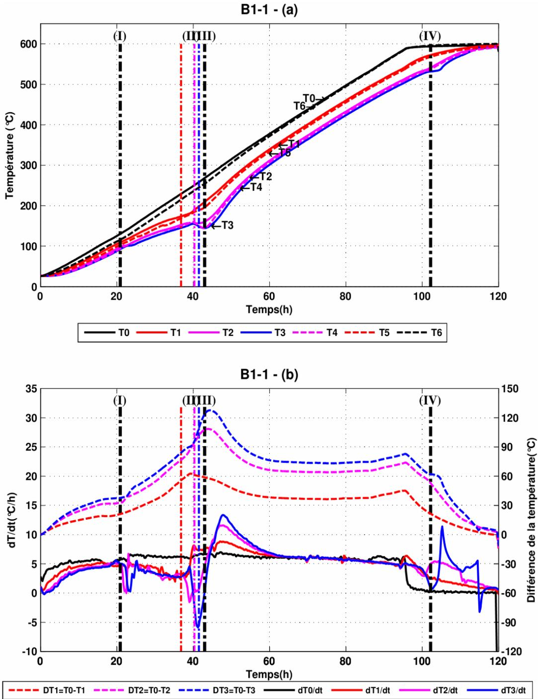
**figure III-17 :** Températures locales et de surface (a) et Dérivée temporelle de température ( $dT/dt$ ) et différences de température entre la surface et les points intérieurs, mesurées sur l'éprouvette de béton B1-1 en fonction du temps (b)
