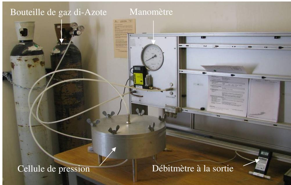
**figure II-9 :** Perméamètre à charge constante Cembureau
