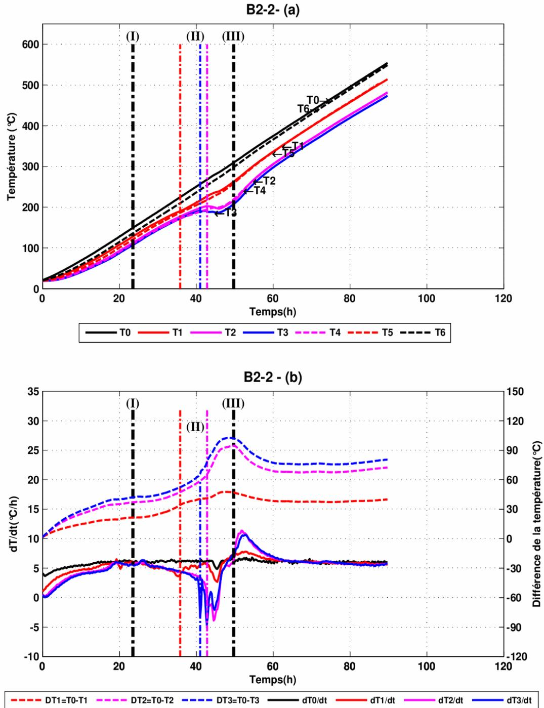
**figure III-20 :** Températures locales et de surface (a) et Dérivée temporelle de température ( $dT/dt$ ) et différences de température entre la surface et les points intérieurs, mesurées sur l'éprouvette de béton B2-2 en fonction du temps (b)
