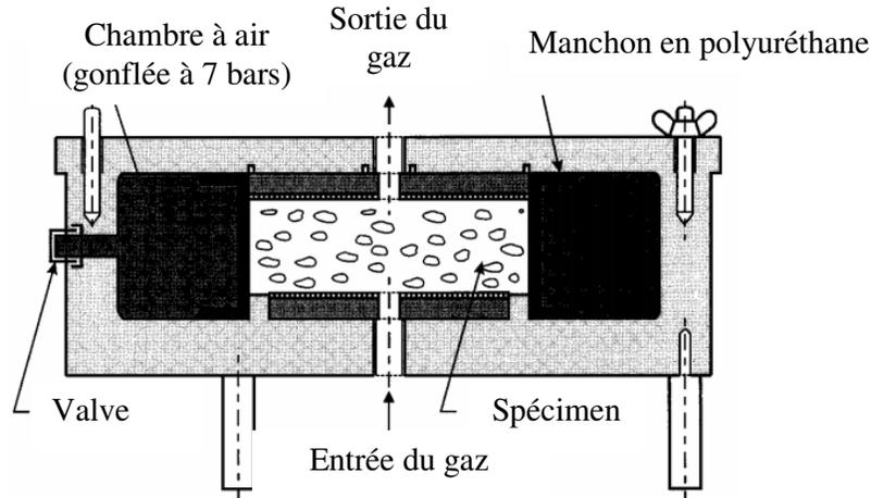
figure II-10 : Cellule du perméamètre au gaz
