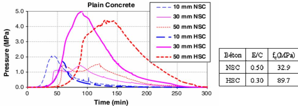
figure I-31 : Évolution de la pression de vapeur en fonction du temps dans des éprouvettes cylindriques ( $\varnothing 175 \times 100$  mm) de BO et BHP soumises à 600°C, avec un chauffage rapide (600°C en 5 minutes) [Bangi et al. 2012]
