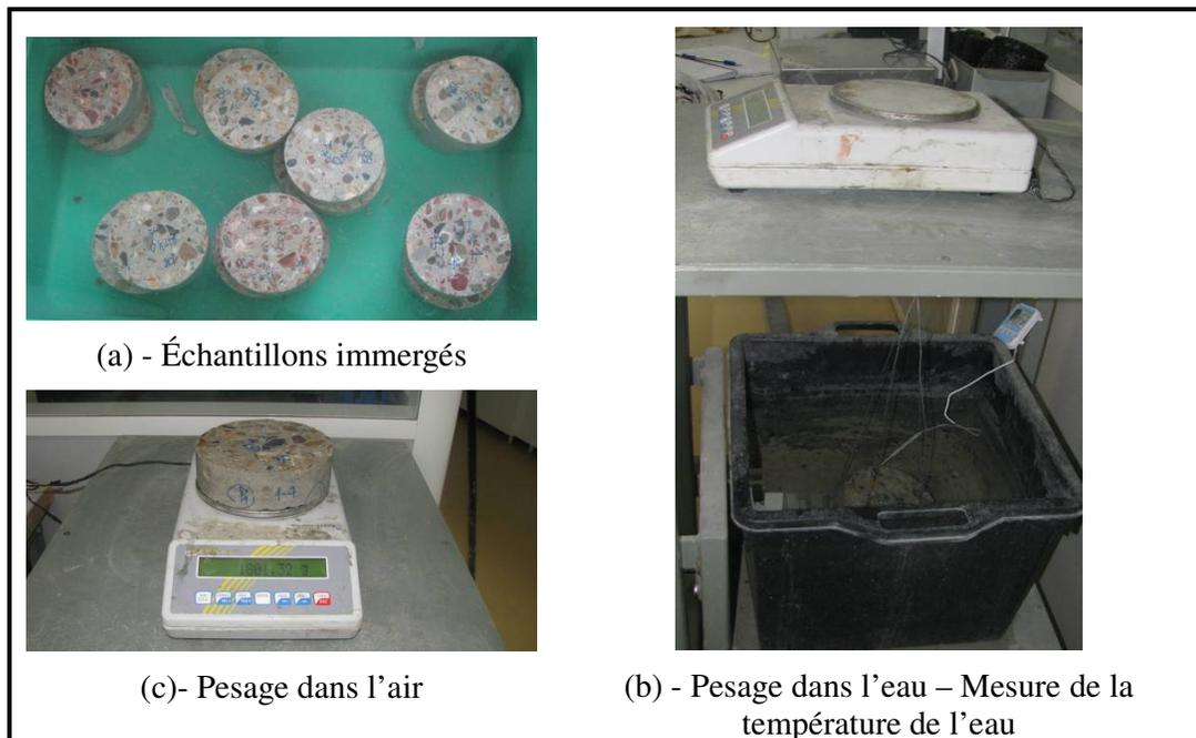
**figure II-12 : Détermination de la masse volumique apparente**
