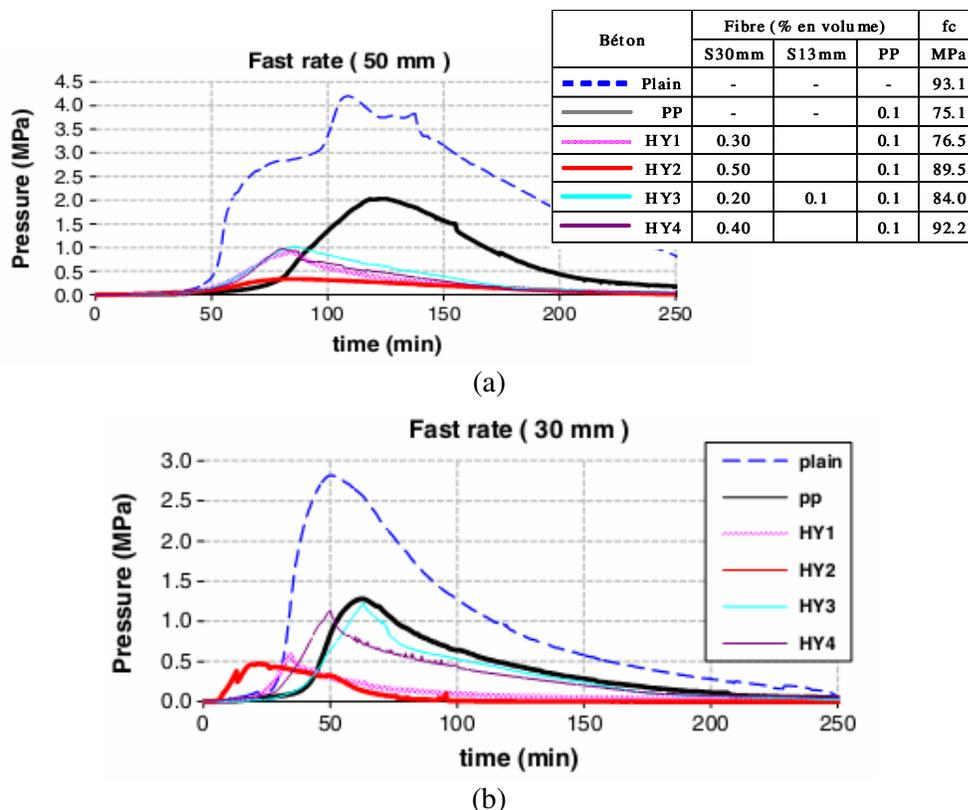
**figure I-36** : Influence des fibres de polypropylène (PP), hybride (HY) sur la pression de vapeur du béton BHP mesurée à 50 mm (a) et à 30 mm (b) de la surface chauffée à une vitesse de 400°C/h [Bangi *et al.* 2011]
