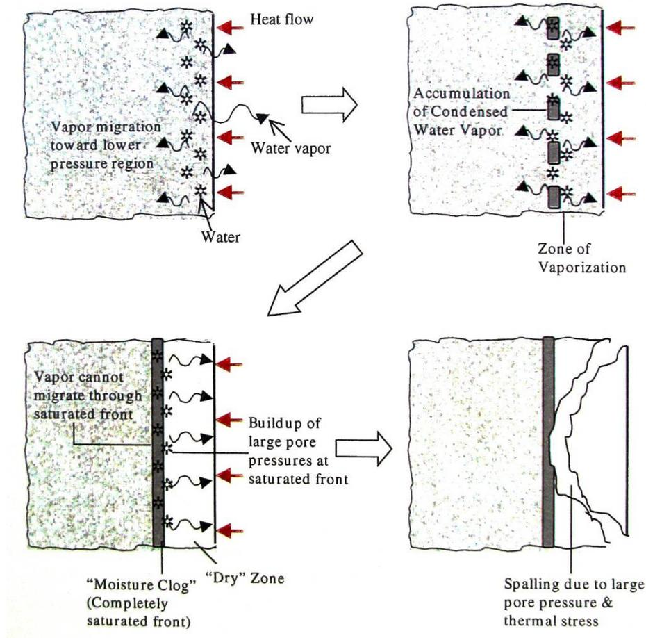
**figure I-1 :** Illustration du mécanisme d'éclatement [Consolazio et al. 1997]
