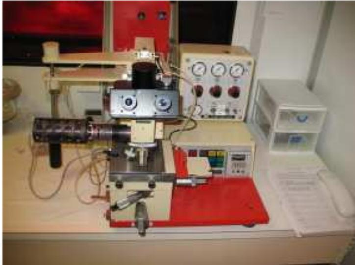
Figure B.3: Photographie de l'aligneur MJB3 Suss Microtech
