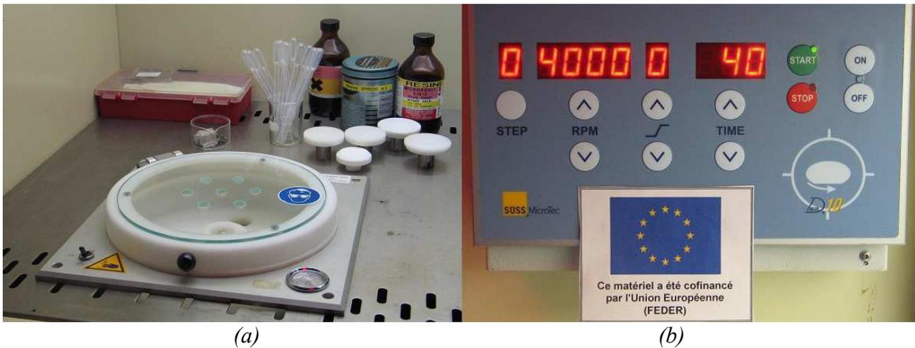
Figure B.2: (a) Photographie de la tournette (b) Photographie du boîtier de commande
