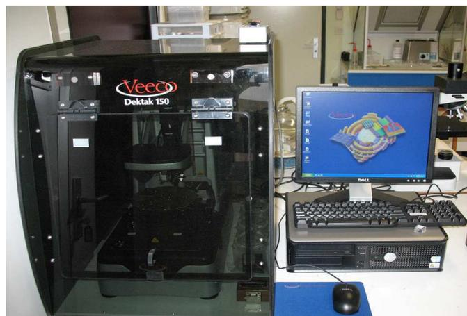
Figure D.2: Photographie du profilomètre
