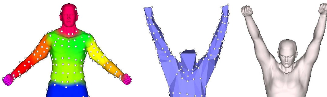
FIGURE 9.4 – Illustration de la méthode de Park et col. [133]. A gauche le partitionnement du maillage en fonction du placement des marqueurs. Au milieu la structure intermédiaire faisant le lien entre les marqueurs. A droite la déformation du maillage obtenu.
