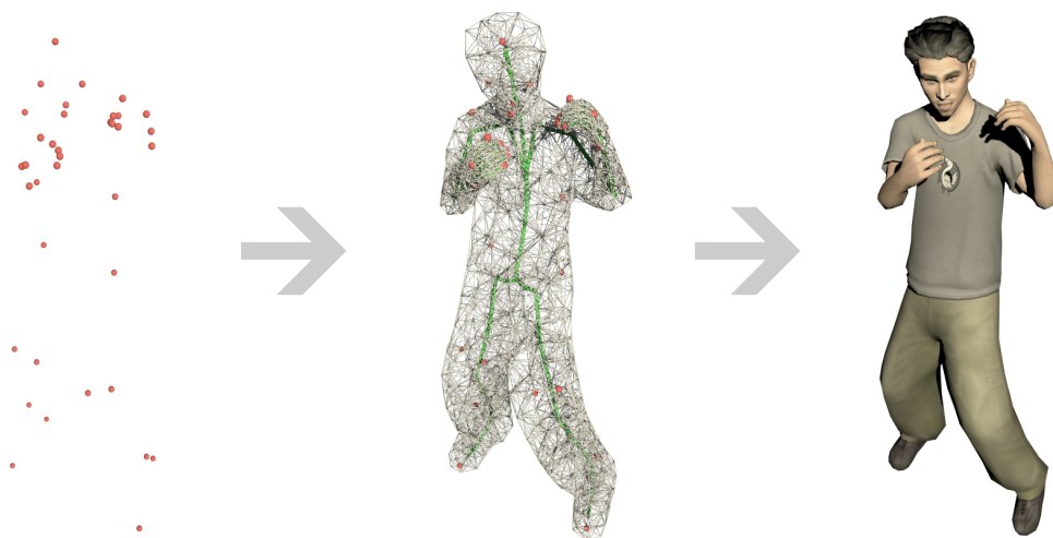
FIGURE 9.1 – Illustration du processus à partir de la spécification d'un nombre réduit de marqueurs issus de la capture de mouvement (image de gauche), notre méthode commence par construire le maillage de contrôle volumique (image centrale) en intégrant le maillage surfacique simplifié ainsi que les informations de rigidité (exprimée sous la forme d'un squelette, finalement doté des limites angulaires des articulations) ; ce maillage est utilisé pour animer le maillage de haute résolution (image de droite)
