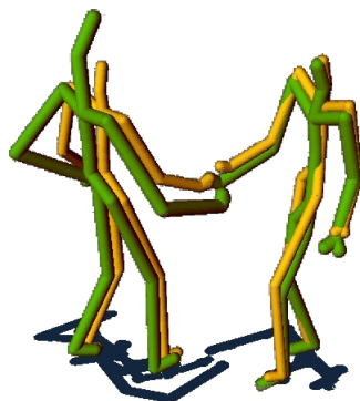
FIGURE 7.9 – Application à l'adaptation de mouvement couplée à l'interaction entre personnages. En jaune les squelettes de référence, en verts les squelettes adaptés.
