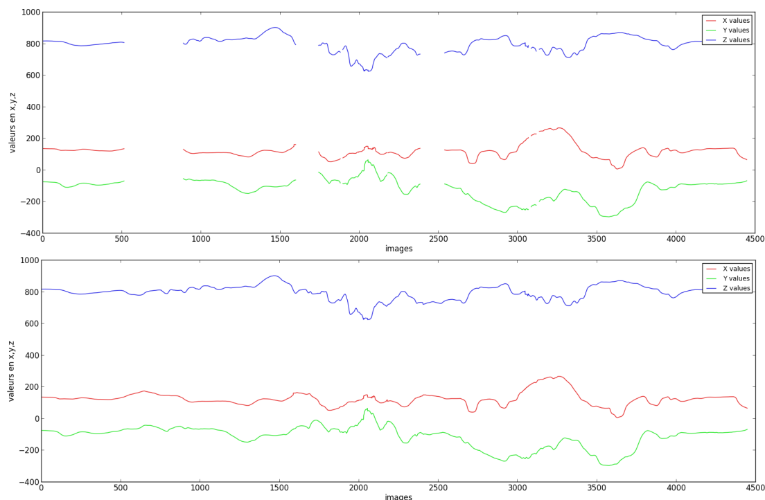
FIGURE 8.1 – Reconstruction de la trajectoire en X (rouge), Y (vert) et Z (bleu) du marqueur du menton avant (en haut) et après (en bas) l’utilisation de notre méthode d’interpolation.
