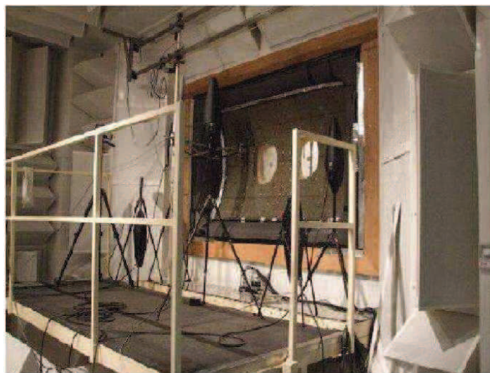
FIGURE 4.5.2 – Panneau de séparation des deux chambres du banc d'essai
