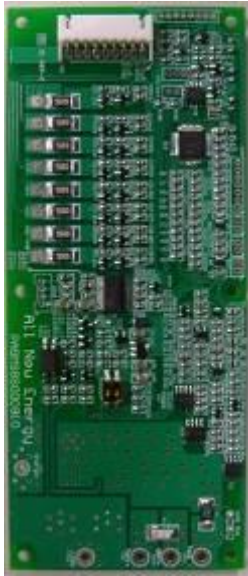
BMS avec équilibrage dissipatif YESA - B24V15(25)
