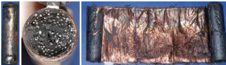
Figure 4 : Cellule cylindrique 18650 après un emballement thermique [5]
