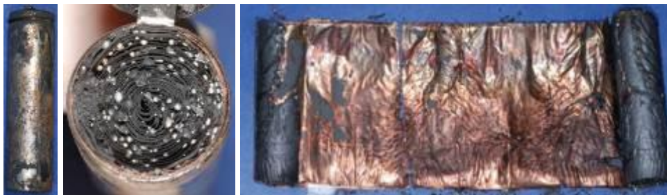
Figure 4 : Cellule cylindrique 18650 après un emballement thermique [5]
