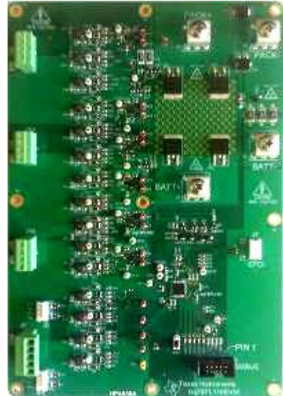
BMS avec équilibrage inductif proche en proche - Démonstrateur Texas Instruments bq78PL116EVM Evaluation Module
