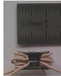
Noyau ER9.5 avec ses colonnes extérieures bobinées et un entrefer sur sa colonne intérieure.
