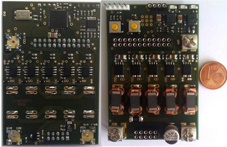
Figure 43 Vue de la face inférieure et supérieure du PCB final d'un bras d'équilibrage
