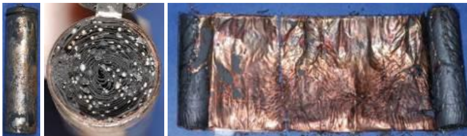
Figure 4 : Cellule cylindrique 18650 après un emballement thermique [5]
