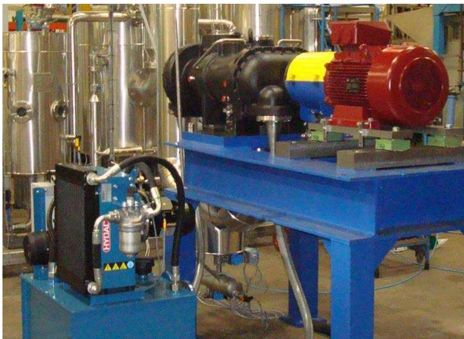
Figure 2. 21. Photographie du compresseur SRM et du groupe hydraulique.
