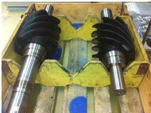
Figure 2. 20. Rotors male (à gauche) et femelle (à droite) du compresseur bi-vis.
