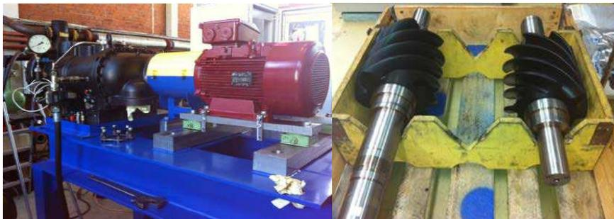
Figure 4. 1. Compresseur bi vis de la vapeur d'eau par SRM
