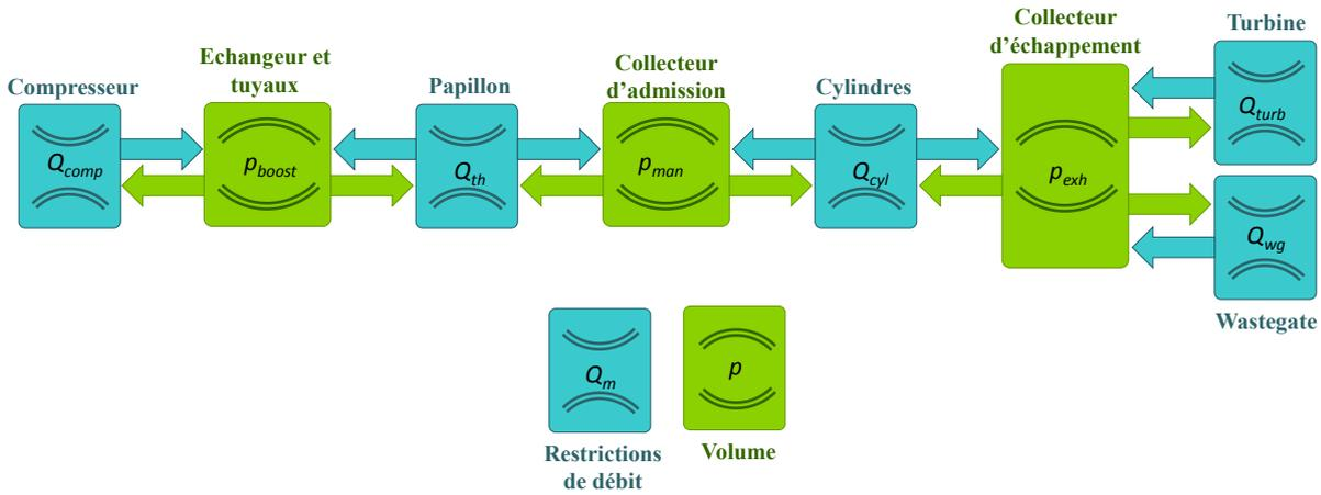
FIGURE 2.39 – Principe de modélisation : discrétisation de la chaîne d'air en éléments restriction ou volume
