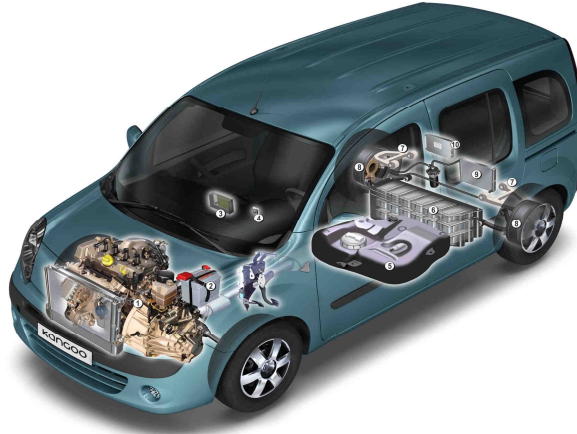
FIGURE 2.16 – Schéma du véhicule hybride électrique Velroue
