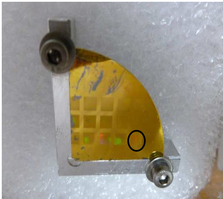
FIGURE 5.8 – Wafer sur lequel a été gravé le réseau de phase utilisé dans toutes nos expériences. Plusieurs zones ont servi de test, la zone cerclée en noir est celle contenant le meilleur réseau.
