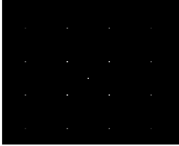
FIGURE 5.16 – Ordres de diffractions transmis directement après un damier de phase binaire dans le cas désaccordé en longueur d'onde : \lambda = 0.9\lambda_0
