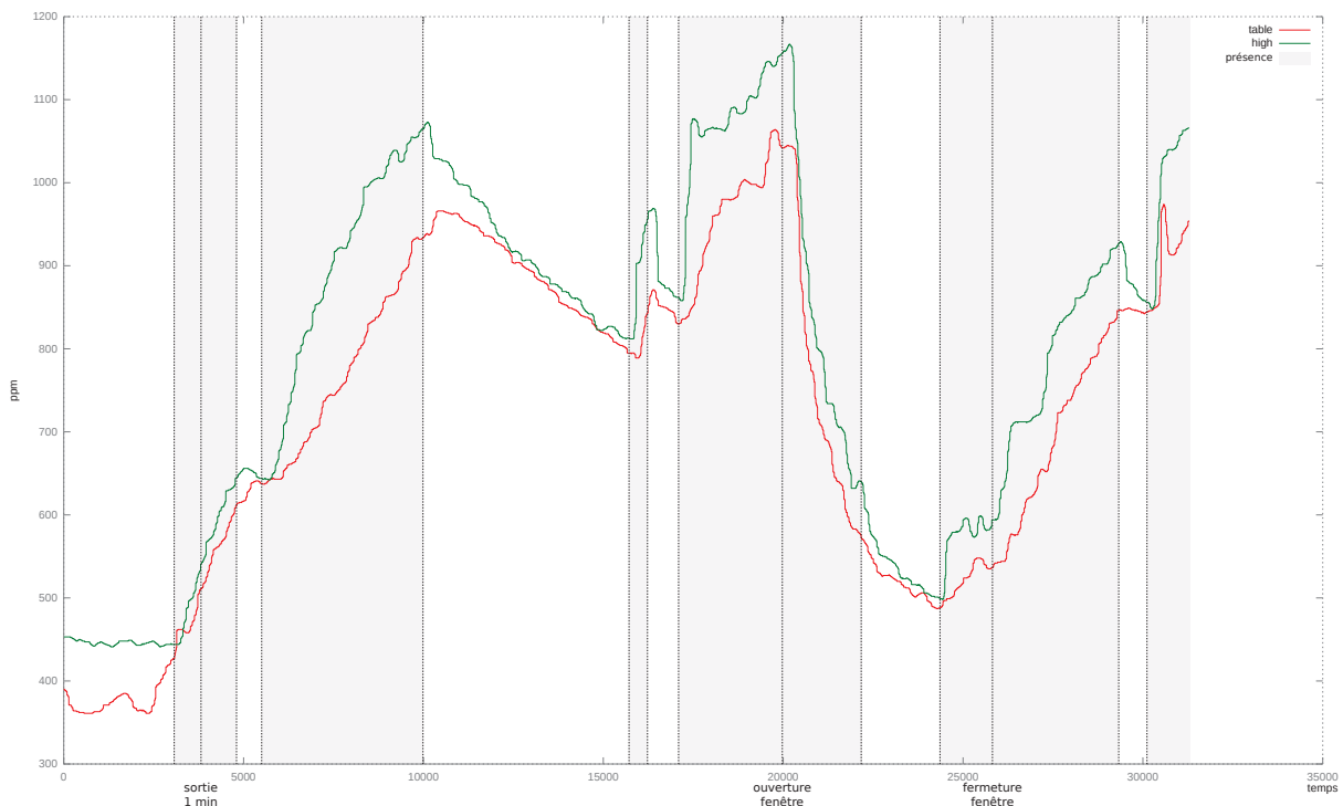
FIGURE 6.9 – Mesures du niveau de CO 2 dans un bureau au cours de la journée. La courbe rouge (au-dessous) correspond aux mesures d'un capteur placé sur une table au centre de la pièce et la courbe verte (au-dessus) celle d'un capteur placé en hauteur sur une armoire. Les intervalles grisés correspondent à la présence d'une personne.
