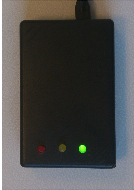
FIGURE 5.5 – Boîtier à LED permettant de simuler les états d’un radiateur augmenté.
