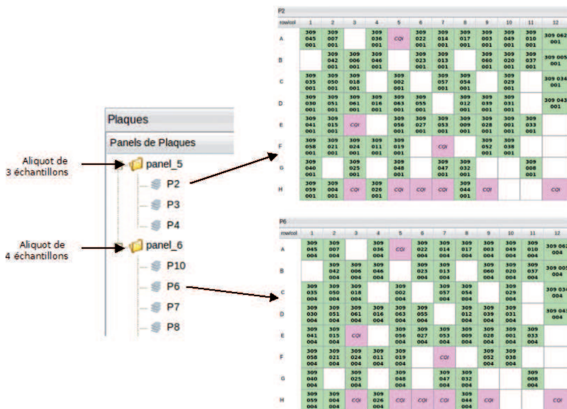
FIGURE 5.2 – Placement des échantillons sur des plaques qui seront introduites dans le spectromètre de masse
