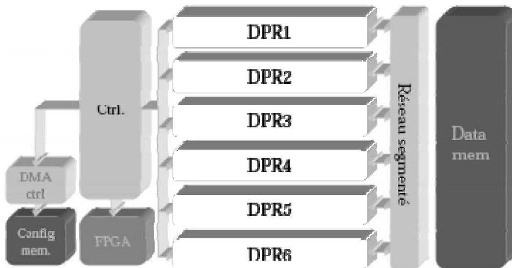
Figure 2.5. Architecture d'un cluster de DART
