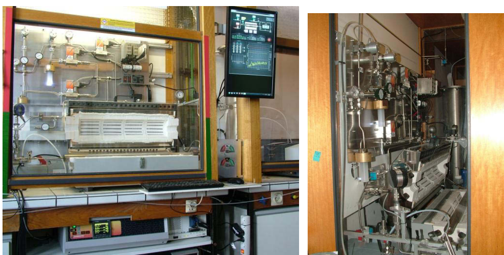
Figure 90. Photographies du nouveau pilote de fluoration conçu pour la fluoration statique
