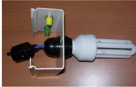
Figure 106. Photo de la lampe alimentée sans câble
