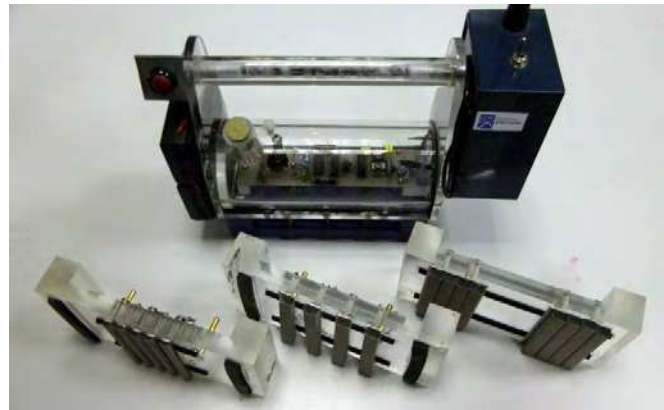
Figure 15 : capacimètre avec des séries d'électrodes de petite à grande taille.
