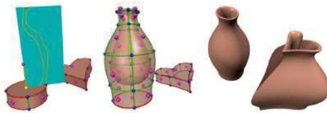
FIG. 3.10 – Image de Bein et al. [BHSF09] illustrant la modélisation par esquisses basée sur des surfaces de subdivision.
