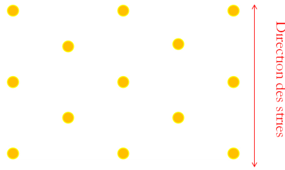
FIGURE 5.2 – Schéma d'un réseau hexagonal distordu = réseau rectangulaire centré. La direction parallèle aux stries est représentée dans le sens vertical.
