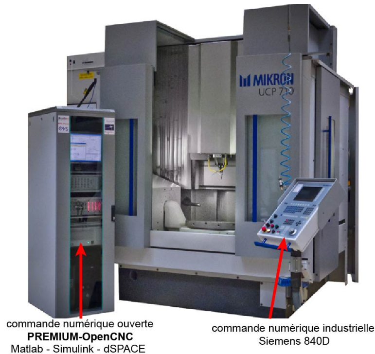
Figure 20 – Photo de la machine Mikron UCP710 équipée de la commande numérique ouverte PREMIUM-OpenCNC
