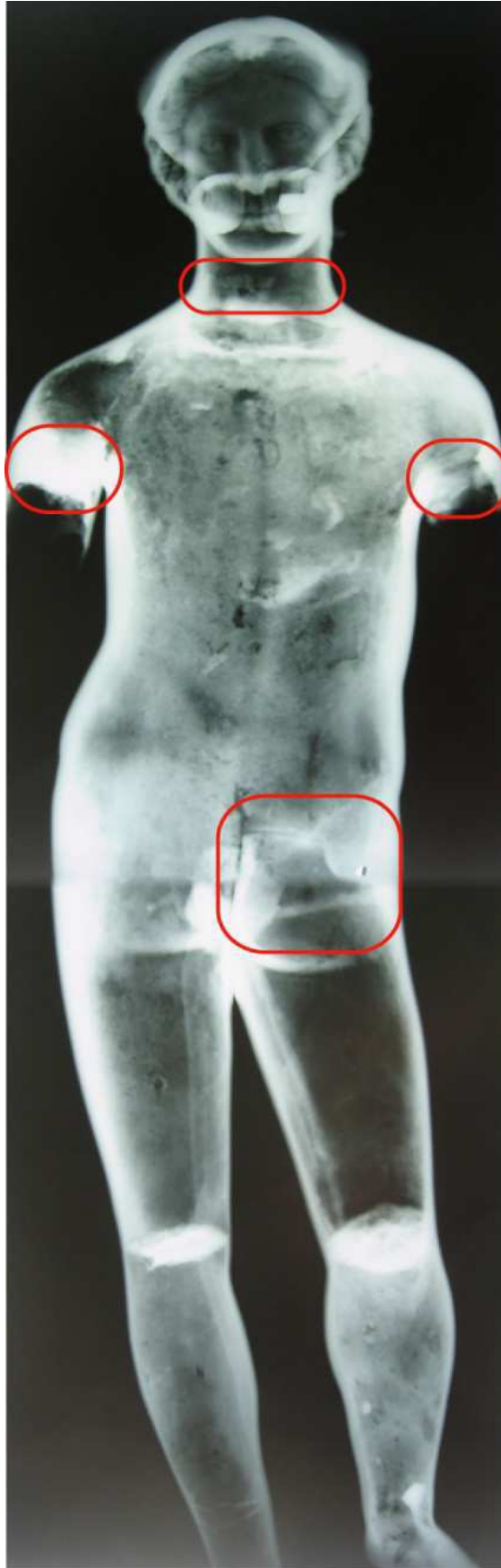
Figure 1.25 : les zones d'assemblage par soudage sont signalées en rouge sur la radiographie X de la statue d'Apollon du Vieil-Evreux (h : 69 cm), 2 e s. ap. J.C., n°inv. 5405, musée d'Evreux ©C2RMF, T. Borel.
