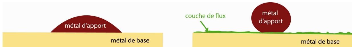
Figure 3.61 : effet du flux sur la mouillabilité du métal de base par le métal d'apport : les forces de cohésion du métal liquide prédominent sur les forces d'adhérence entre le métal de base et le métal d'apport (la goutte de métal « roule »).
