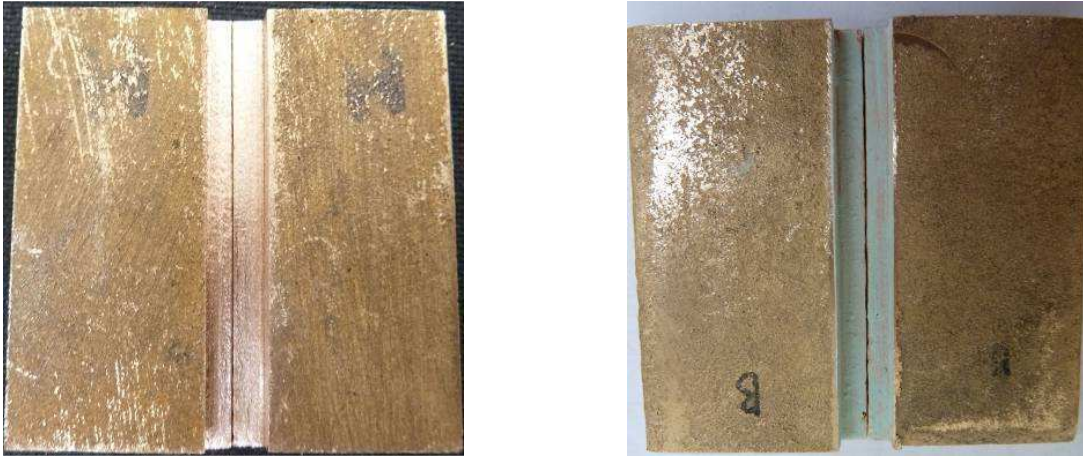
Figure 3.8 : de gauche à droite, avant et après dépôt de turquoise finement broyée sur les bords des pièces à assembler
