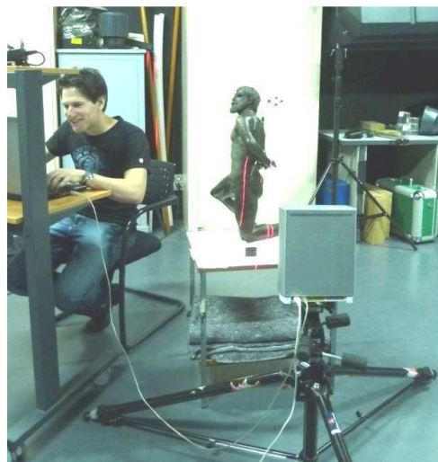
Figure 1.9: Scan 3D par triangulation laser du Gaulois captif d'Arles Gaulois captif d'Arles, (h : 0,63 cm, 1 er s. av. J.C., n°inv.Rho.2007.06.1962, MDA).
