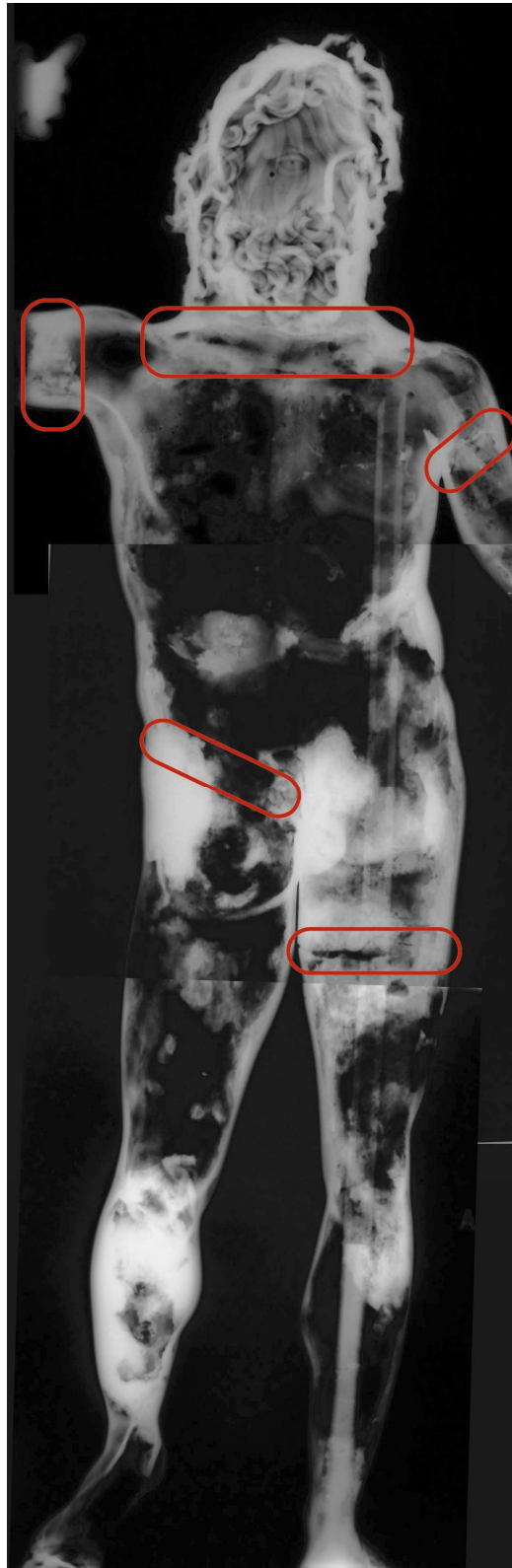
Figure 1.30 : les zones d'assemblage par soudage sont signalées en rouge sur la radiographie X de la statue de Jupiter du Vieil-Evreux (h : 92 cm), 1 e s. ap. J.C., n°inv. 5404, musée d'Evreux ©C2RMF, T. Borel. NB : comme pour Apollon, les bandes rectilignes plus claires qui traversent la statue de haut en bas correspondent à des armatures modernes installées lors de la première restauration de la statue [Szewczyk 2010].
