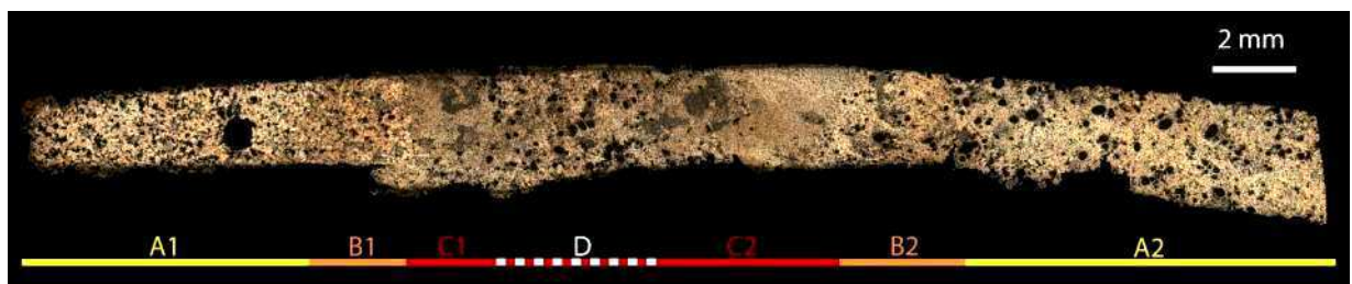
Figure 2.49 : Localisation des différentes zones, image au microscope optique, après attaque chimique au chlorure ferrique ; fragment issu d'une statue équestre monumentale, C2RMF 69362, 1 er s. ap. J. C., musée d'Evreux, Evreux.
