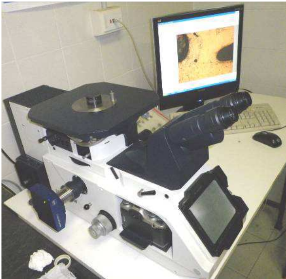
Figure A.7 : à gauche, microscope optique inversé Leica du DCCI de Gênes ; à droite, coupe métallographique d'un essai de soudage en laboratoire (E49, Zone 2, métal de base en bas/métal d'apport en haut).
