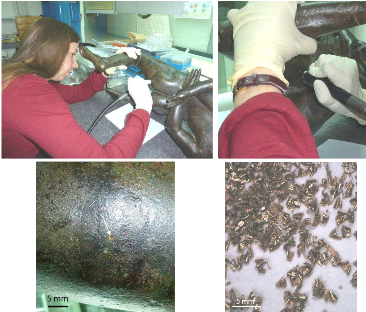
Figure 1.8: En haut, prélèvement du métal de soudure entre la jambe gauche et la partie supérieure de la cuisse gauche du Gaulois captif d'Arles (h : 0,63 m), 1 er s. ap. J.C., n°inv. Rho.2007.06.1962, MDAA ; En bas à gauche, détail du prélèvement de métal dans une cuvette de soudure ; en bas à droite, copeaux de métal prélevés ©C2RMF, B. Mille.
