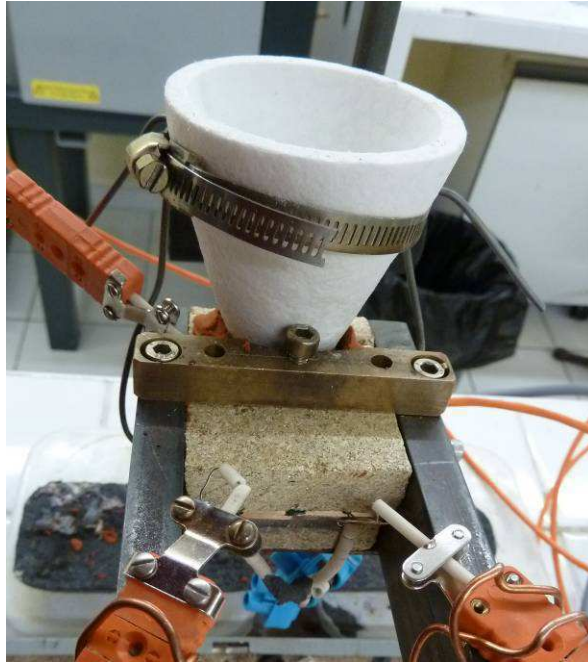
Figure 3.12 : un cône en fibre céramique est placé au niveau de l'ouverture creusée dans le réfractaire, au dessus de l'entrée du canal.
