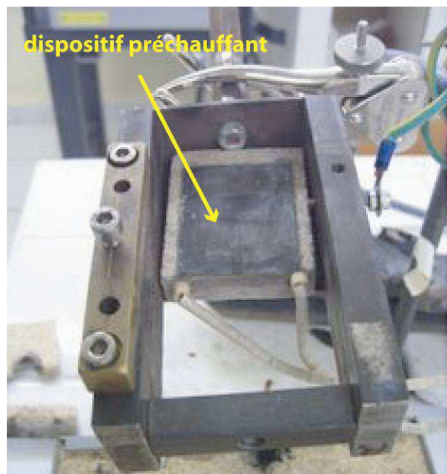
Figure 3.10 : le dispositif préchauffant (en noir) est monté sur une pièce de réfractaire adaptée aux dimensions du porte-échantillon. Les deux fils sortant de la plaquette permettent l'alimentation en électricité de celle-ci.
