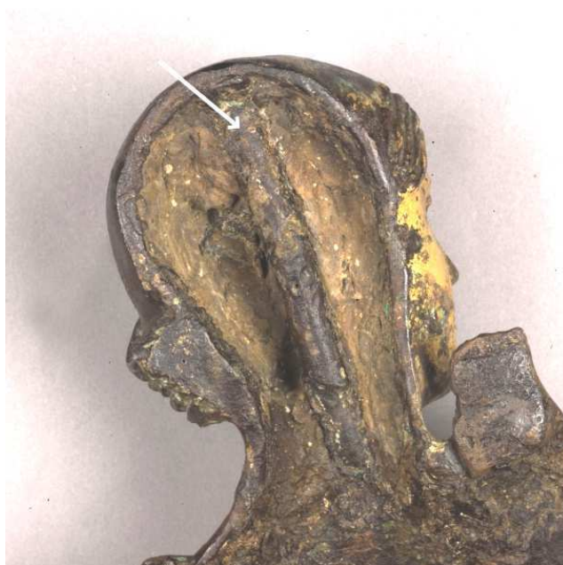
Figure 1.18 : canal d'alimentation sur le revers de la Victoire dorée d'Arles (h : 76 cm), 1 er s. av. J.C.-1 er s. ap. J.C., n° inv. Rho.2007.05.1961, MDAA, ©C2RMF, D. Bagault.
