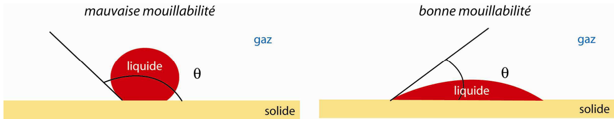
Figure 3.60 : les différents cas de mouillage d'un solide par un liquide. Ils se caractérisent par l'angle de contact \theta .
