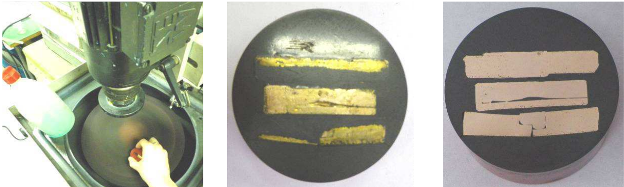
Figure A.5 : à gauche, polissage manuel d'un échantillon ; au milieu, échantillon avant polissage ; à droite échantillon après polissage
