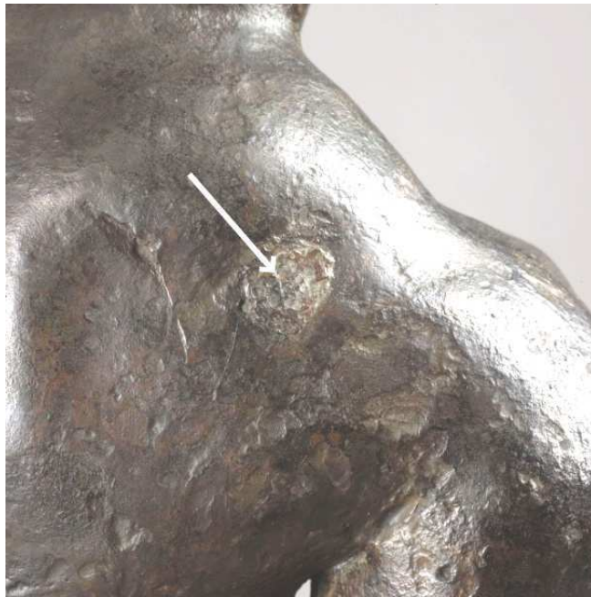
Figure 1.14 : accumulation de plomb entourée de plaquettes de réparation au niveau de l'omoplate droite du Gaulois captif d'Arles, (h : 63 cm), 1 er s. av. J.C., n°inv. Rho.2007.06.1962, MDAA, ©C2RMF, D. Bagault.
