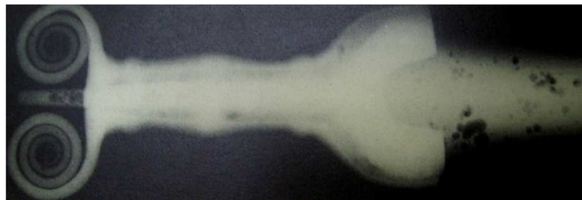
Figure 2.13 : Epée en bronze (L : 49,5 cm), n°lg 4146a, première moitié du II e s. av. J.C., museum für Vor- und Frühgeschichte, Berlin. La poignée a été rapportée par coulée secondaire. Cette dernière a visiblement provoqué la fusion partielle de la partie de la soie qui était en contact [Hermann 1985].
