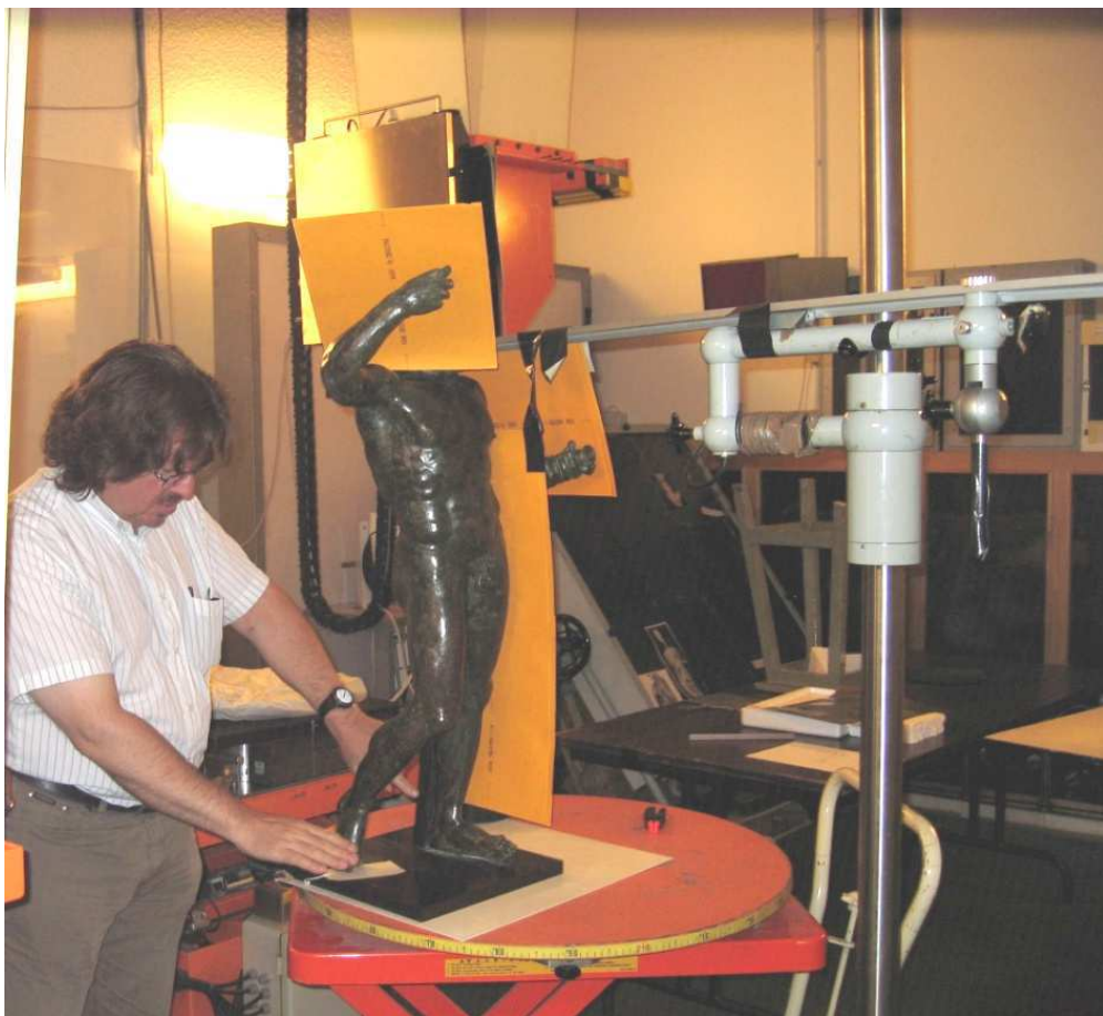
Figure 1.7 : mise en place par Thierry Borel des films radiographiques autour de Jupiter d'Evreux.
