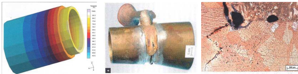
Figure 3.2 : à gauche, simulation des variations thermiques intervenant sur une pièce préparée en cordon « sur métal » lors de la coulée du métal d'apport ; au milieu, essai en laboratoire correspondant à la simulation : le métal d'apport s'est solidifié avant d'avoir rempli le canal sur toute la longueur du joint ; à droite, coupe métallographique transversale de l'assemblage résultant : le métal de base est en bas (large microstructure) tandis que le métal d'apport se situe en haut à droite (fine microstructure) [à partir de Zimmer et al/ 2011].
