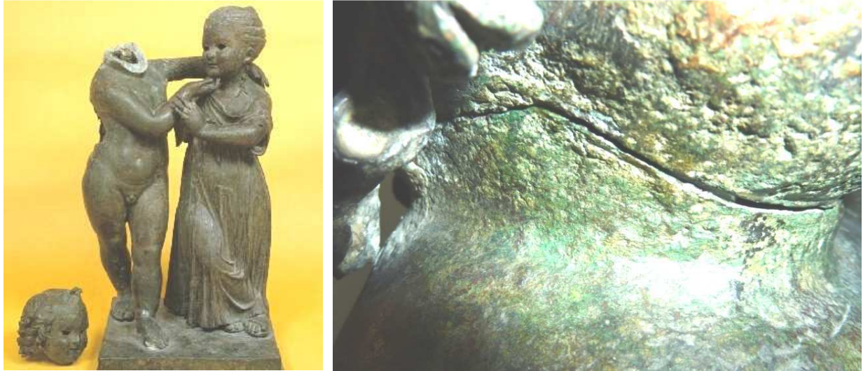
Figure 2.37 : à gauche, vue d'ensemble de la sculpture ©C2RMF ; à droite, détail de la jonction tête-corps d'Eros, une fois la tête remontée ; Eros et Psyché, (H : 72,5 cm), n°inv. Br 4105, époque romaine, département des AGER, musée du Louvre. Statues dont l'assemblage de la tête sur le corps a été préparé en « plateformes ».
