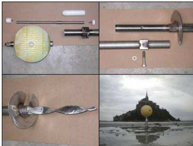
Fig. 55 : Nouvelle structure du courantomètre S4DW et situation sur le terrain.
