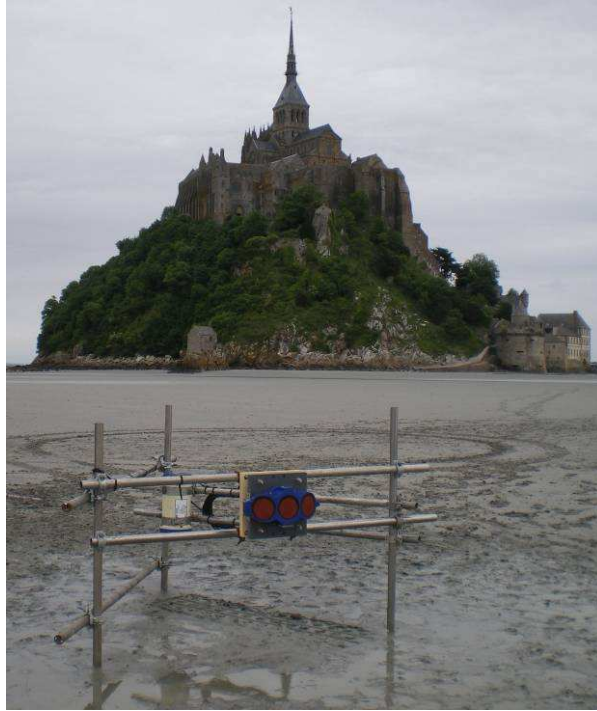
Fig. 97 : H-ADCP sur sa structure.
