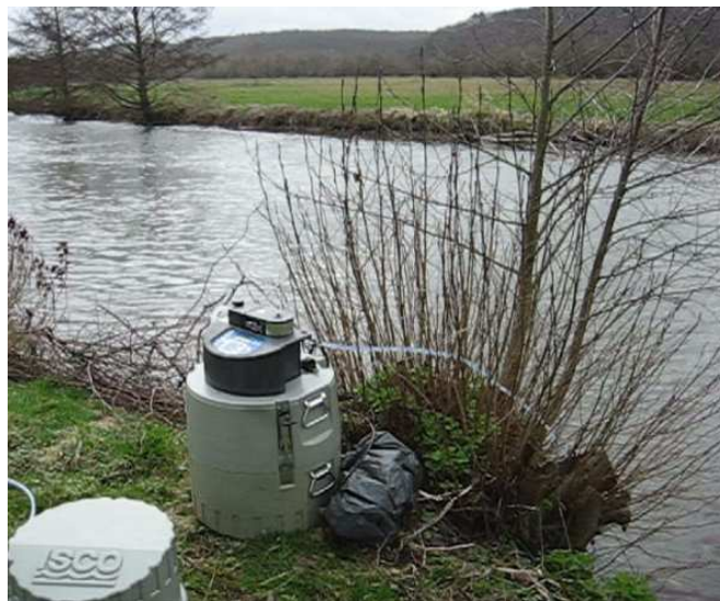
Figure 29: Exemple d'installation d'un site de mesures haute fréquence.
