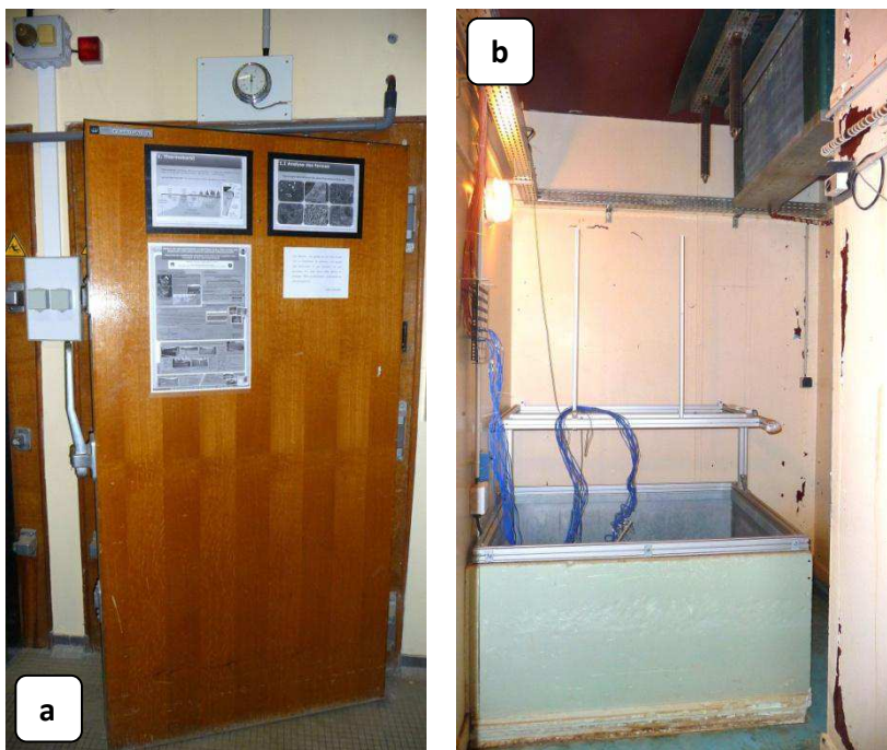
Figure 25 : a) Porte de la chambre froide utilisée pour l'expérimentation ; b) vue de l'intérieur de la chambre froide. L'évaporateur est visible en haut à droite de la photographie.
