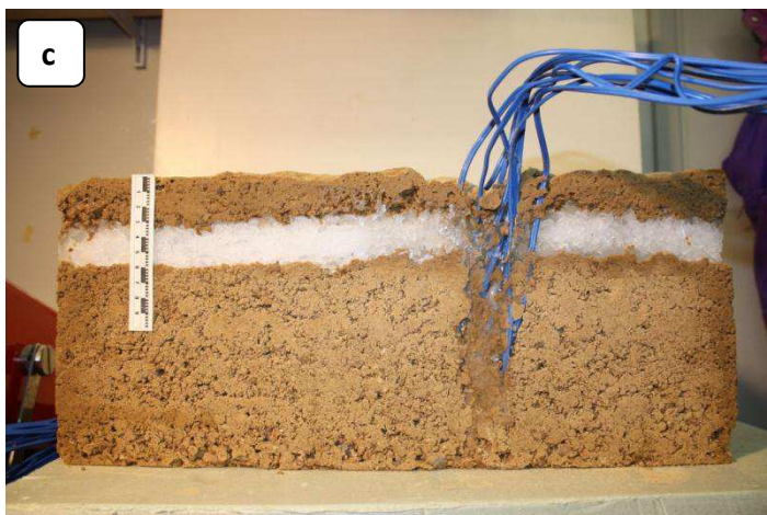
Figure 50 : a) Mise en place d'une couche de glace en sub-surface d'un bloc de pergélisol expérimental ; b) Couche de paillettes de glace colorées avec une solution de bleu de méthylène ; c) Couche de glace visible une fois le bloc « dé-moulé », exemple du modèle D4.
