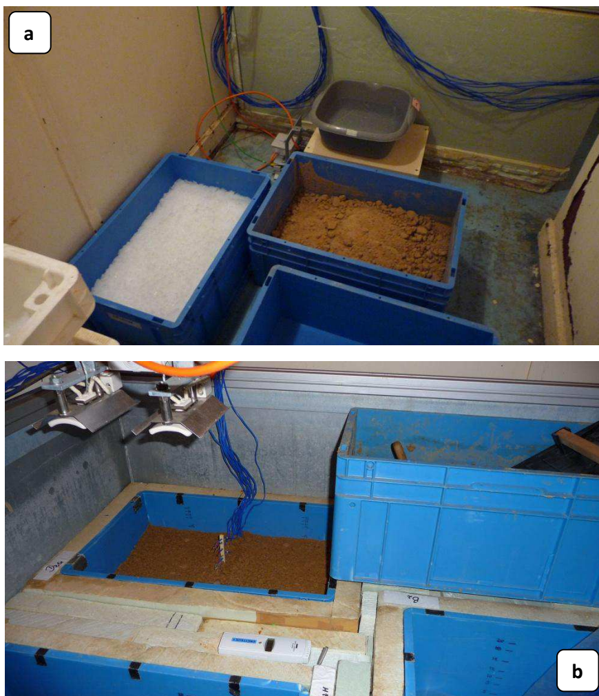
Figure 37 : a) Différents constituants des blocs de pergélisol expérimental : eau proche de 0 °C (cuvette grise), paillettes de glace (bac de gauche) et mélange de sédiments (bac de droite) ; b) Modèle en cours de remplissage. Les thermocouples sont en partie déjà enfouis au centre et le dispositif de dégel est également visible au-dessus.
