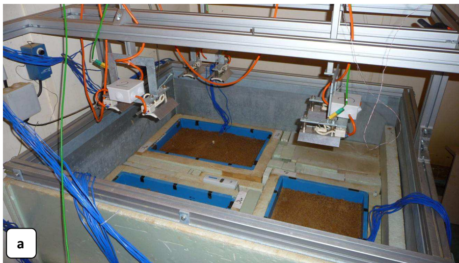
Figure 38 : a) Vue des modèles une fois leur mise en place terminée ; b) Schéma de la disposition des modèles dans l'enceinte dans la chambre froide. L'espace entre les bacs est comblé par de l'isolant. Sont visibles les thermocouples, la sonde Pt100 qui indique la température ambiante et les deux enregistreurs de l'humidité relative de la pièce.
