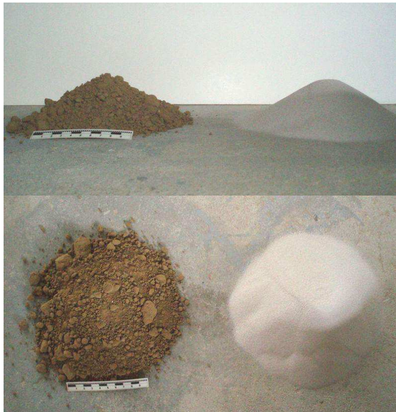
Figure 35 : Sédiments servant aux différents mélanges. A gauche, limons de la plaine de Caen (non tamisés), à droite, sable de Nemours.
