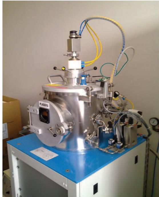
Figure II-1 Bâti de pulvérisation cathodique en continu.
