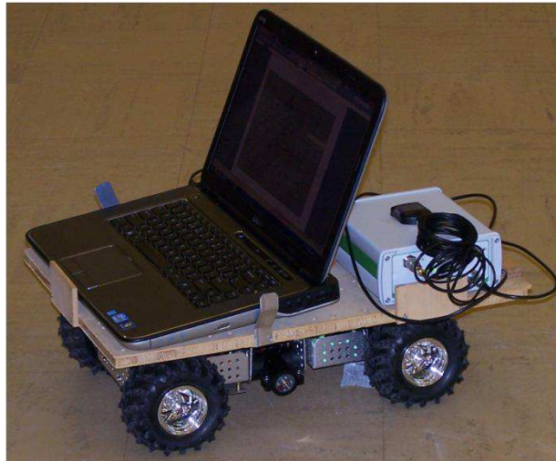
Figure IX-8 : robot téléguidé portant le récepteur GNSS et l'antenne réceptrice
