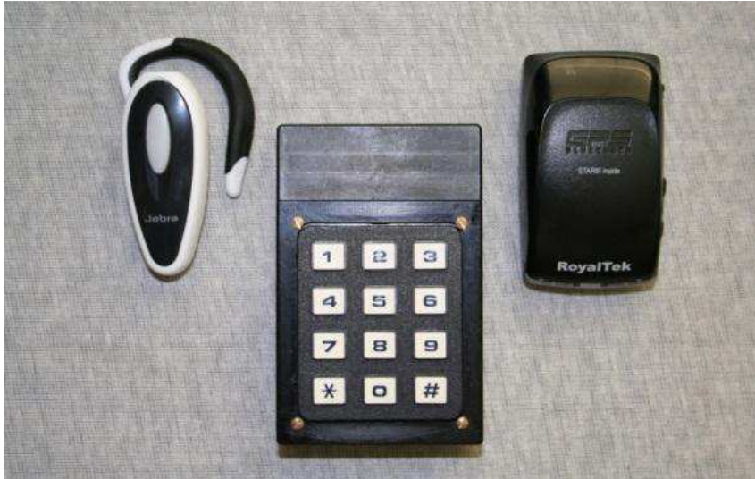
Figure 1.12 Géotact V2 (clavier, récepteur GPS SIRF-III et oreillette communiquant par Protocole Bluetooth).
