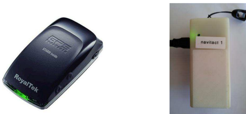
Figure 4.10 A gauche: antenne SIRF-III liaison Bluetooth. A droite: Centrale Inertielle en état de charge (lumière verte allumée).
