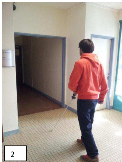
Figure 2. 42 (1) Proximètres infrarouge pointant horizontalement et un autre pointant à 45 degrés vers le haut ; (2) Détection de hauteur de plafond avec le proximètre infrarouge qui pointe vers le haut ; (3) Proximètre infrarouge horizontal pour trouver les passages de portes.
