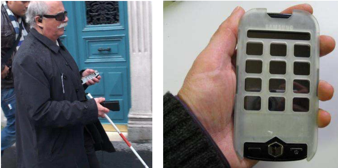
Figure 3.10 A gauche : non-voyant utilisant l'appareil dans une main. A droite : le masque avec le Smartphone OMNIA I8000.
