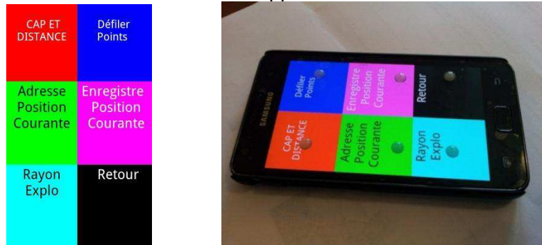
Figure 3.11 A gauche : exemple de distribution de boutons dans l'écran. A droite : le Smartphone Galaxy S2 avec des boutons et petites boules de colle sur l'écran.
