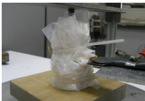
Figure II-29 : Photographie présentant l'échantillon entouré d'un linge humide et d'un film plastique protecteur.
