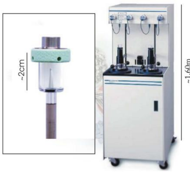
Figure II-14 : Pénétromètre (1) introduit dans le porosimètre (2) de type Autopore IV 9500 de chez Micromeritics.
