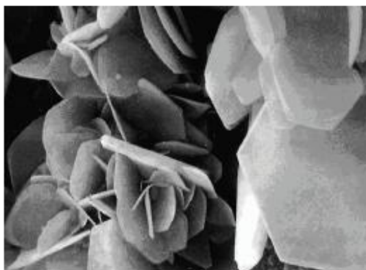
figure I-28 : plaquettes hexagonales de sel de friedel par réaction entre C_3A et le chlorure de sodium observé au MEB au LERM 2012 , b) [Escadeillas et Hornain, 2008].
