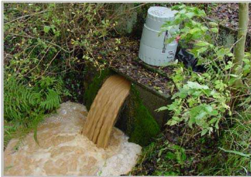
Figure 1.8: Exemple de turbidité observée au niveau de la source de Bourdainville en octobre 2000; la turbidité a atteint la valeur maximale de 2950 NTU (Dussart-Baptista, 2003)
