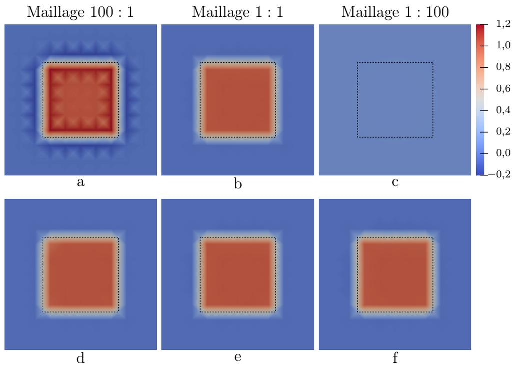
**FIGURE F.4** – Effet d'échelle de la constante de Sobolev. Maillages respectivement à l'échelle 100 (a, d), 1 (b, e) et  $1/100$  (c, f). Les deux figures du centre (b, e) reprennent le cas test de la partie F.1. **1<sup>ère</sup> ligne (a, b, c)** : constante de Sobolev égale à  $2 \cdot 10^{-3}$ . **2<sup>ème</sup> ligne (d, e, f)** :  $\alpha$  valant  $2 \cdot 10^1$ ,  $2 \cdot 10^{-3}$  et  $2 \cdot 10^{-7}$ , respectivement pour d, e et f.
