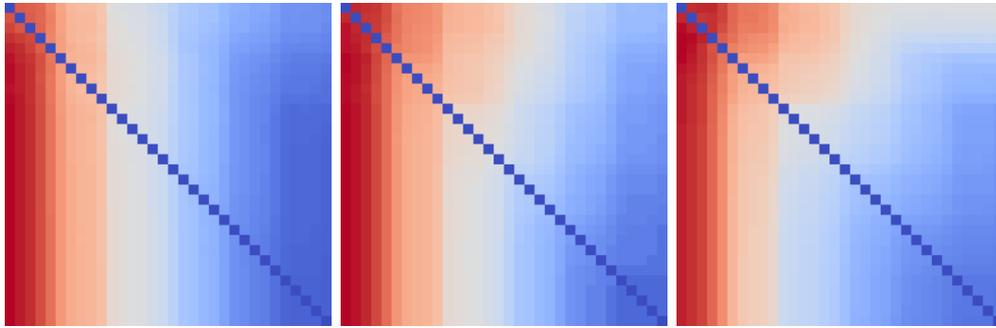
**FIGURE 2.14** – Erreur pour des transferts nodaux en fonction des maillages. Chaque terme matriciel  $M_{ij}$  représente l'erreur de projection nodale  $\epsilon_{glob,c}^{\%}$  du  $i^{\text{ème}}$  maillage vers le  $j^{\text{ème}}$  maillage. **De gauche à droite** : erreur d'interpolation, de projection  $\mathcal{L}^2$  et  $\mathcal{H}^{grad}$ .
