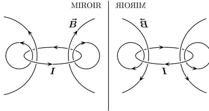
**FIGURE 1.1** – Représentation d’une bobine et de son image par la transformation  $(e_x, e_y, e_z) \rightarrow (-e_x, e_y, e_z)$  (LÉVY 2005).
