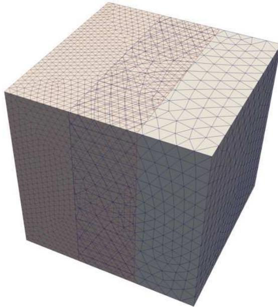
**FIGURE 2.2** – Représentation schématique des deux maillages utilisés pour les tests de transferts. La fonction analytique est initialement discrétisée sur le maillage fin (à gauche) et transférée sur le maillage épars (à droite). La partie centrale de la figure montre la superposition des deux maillages.
