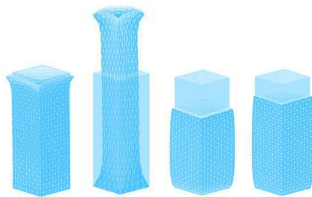
**FIGURE C.5** – *Représentation des déformées pour un aimant. De gauche à droite : Formulation électrique-expression 1, formulation électrique-expression 2, formulation magnétique-expression 1, formulation magnétique-expression 2.*
