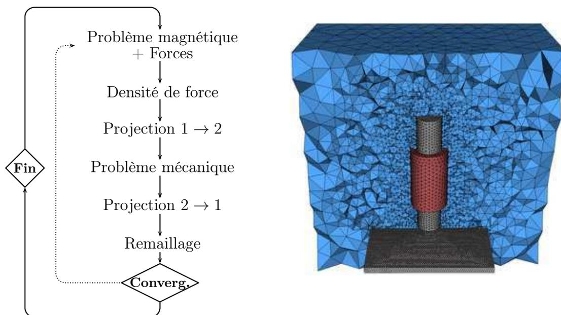
**FIGURE 1.11** – *Gauche* : schéma global de couplage. *Droite* : maillage magnétique (300 000 tétraèdres linéaires).
