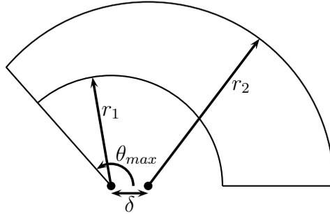
**FIGURE 1.2** – Structure et définitions du coude à changement de section.
