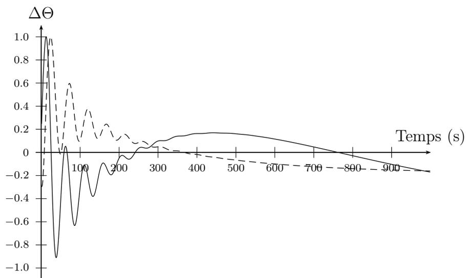
**FIGURE 1.29** – *Trait plein* : tracé de la différence normalisée entre la température réelle et la courbe exponentielle (cherchée au sens des moindres carrés) *Tirets* : valeur normalisée du déplacement, on observe bien le déphasage de  $\pi/2$ .
