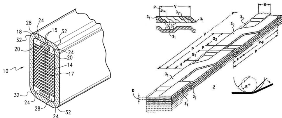
**FIGURE 5** – *Structure de Roebel d'une barre de conducteur. Gauche : une section de barre, les brins sont au centre (YOUNSI et al. 2004). Droite : détail des différentes permutations le long du conducteur (ALBRECHT et MASSEK 2004).*
