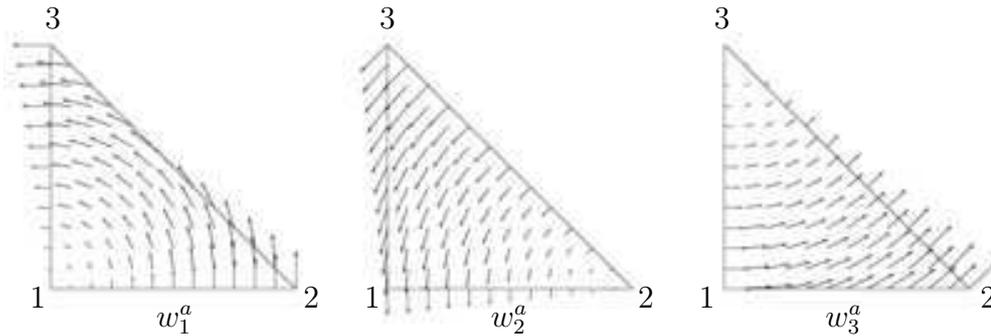
**FIGURE 4.1** – Tracé, pour un élément bi-dimensionnel des champs générés par les fonctions de base de Nédélec (ERN 2005).
