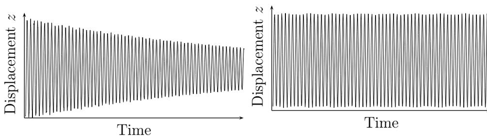
**FIGURE 1.19** – Tracé du déplacement sur toute la durée de la modélisation (cas centré,  $\Delta/2$ ). **Gauche** : pas de boucle interne, un amortissement numérique est constaté. **Droite** : boucle interne activée, pas d'amortissement constaté.
