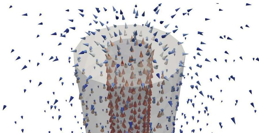
**FIGURE 2.8** – Potentiel intermédiaire utilisé pour l'annulation de la divergence. L'équations utilisée a la même structure que celle utilisée pour la résolution magnétostatique, le champ source peut être assimilé à celui produit par la bobine dans la boîte  $\mathcal{D}_{\text{boi}}$ .
