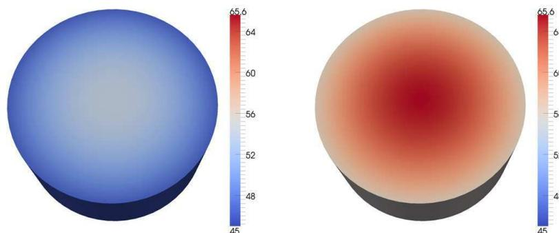
FIGURE 1.23 – *Gauche* : distribution de température obtenue à l'état final par la méthode d'interpolation. *Droite* : distribution pour les méthodes conservatives locales et de projection orthogonale.
