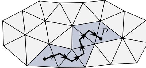
**FIGURE 3.2** – Recherche de l'élément contenant le point  $P$  : le trajet symbolise la liste des éléments successivement testés. Grâce à la recherche directionnelle, seuls les triangles grisés sont testés.
