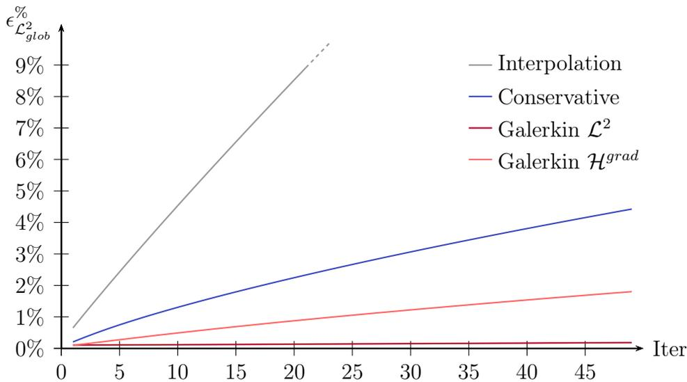
FIGURE 2.3 – *Éléments finis nodaux* – Évolution de l'erreur  $\epsilon_{\mathcal{L}^2_{glob}}^{\%}$  pour des éléments cibles linéaires. Transfert et mesure de l'erreur effectués en norme  $\mathcal{L}^2$ .
