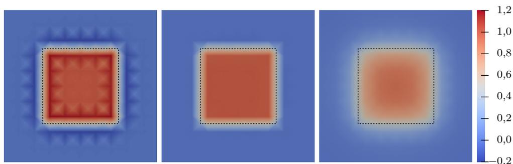
**FIGURE F.3** – Cubes concentriques – Résultat des projections  $\mathcal{L}^2$  (à gauche) et  $\mathcal{H}^{grad}$  avec une constante de Sobolev de  $2 \cdot 10^{-3}$  (au centre) et  $2 \cdot 10^{-2}$  (à droite).
