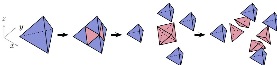
FIGURE 4.1 – Exemple de découpe d'éléments pour un tétraèdre.
