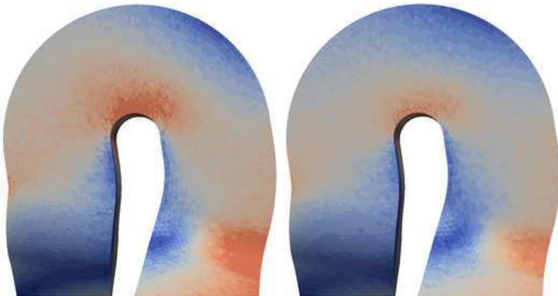
**FIGURE A.1** – Exemples de répartitions des contraintes totales pour le coude supérieur de la développante. **Gauche** : Résolution électrocinétique (voir figure 1.4). **Droite** : Courant source uniforme.
