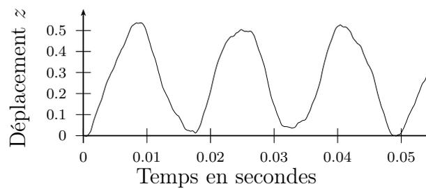
**FIGURE 1.16** – Tracé partiel de  $z = \|u(P) - u_{t_0}(P)\|$ .
