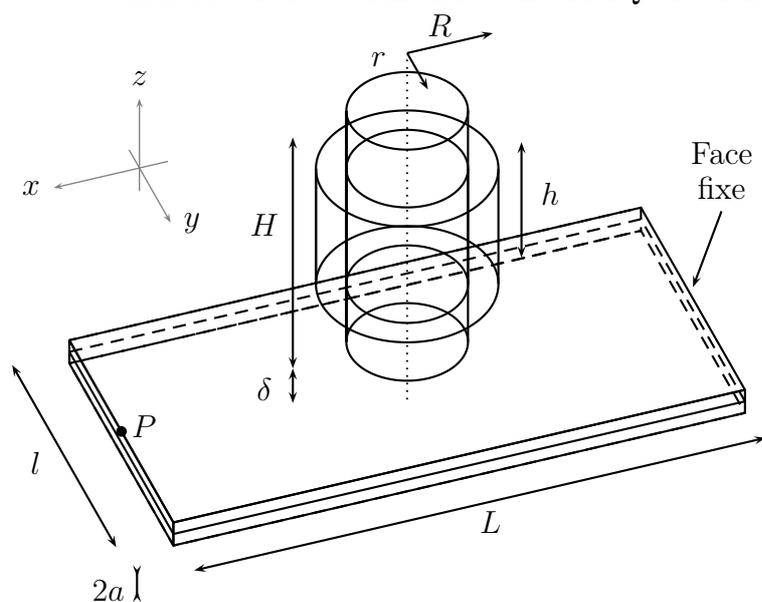
FIGURE 1.26 – Détail et paramètres du bilame modélisé.
