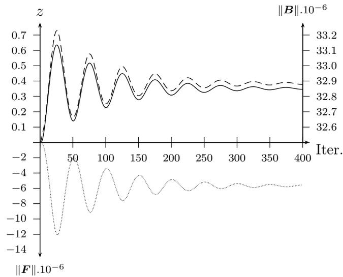
**FIGURE 1.12** – *Traits plein* : déplacement vertical du point  $P$  par analyse temporelle. *Tirets* : Norme de l'induction magnétique au centre du noyau. *Traits pointillés* : force totale, selon l'axe  $z$ , appliquée au noyau de fer.
