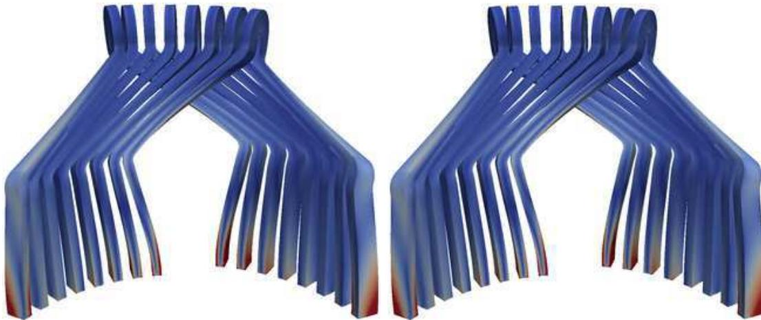
**FIGURE D.2** – Déformations au sein de la structure ( $\times 10^8$ ), la surface est colorée par la norme de Frobenius du tenseur des contraintes. La différence relative en norme entre les deux méthodes est de 7%. **Gauche** : Méthode Éléments Finis. **Droite** : Modèle purement analytique.
