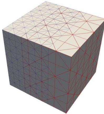
**FIGURE 2.18** – Exemple schématique de maillage subdivisé. Maillage 1 en bleu et maillage 2 en rouge. Les deux maillages sont basés sur un cube d’arête unitaire. La superposition des maillages est présentée au centre de la figure.
