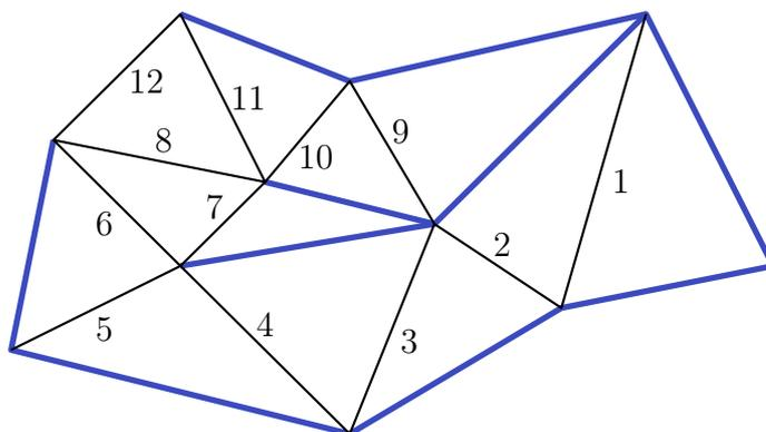
**FIGURE 2.2** – Exemple équivalent d'un arbre de facettes pour un maillage 2D triangulaire. Le DdL de la face 1 peut être déduit des DdL du bord du domaine, puis par calculs successifs les DdL des faces 2, 3, 4, 5 et 6 sont également déterminés. La même méthode est appliquée aux faces 7, 9, 10 et 11 permettant ainsi de déduire 8 puis finalement 12.
