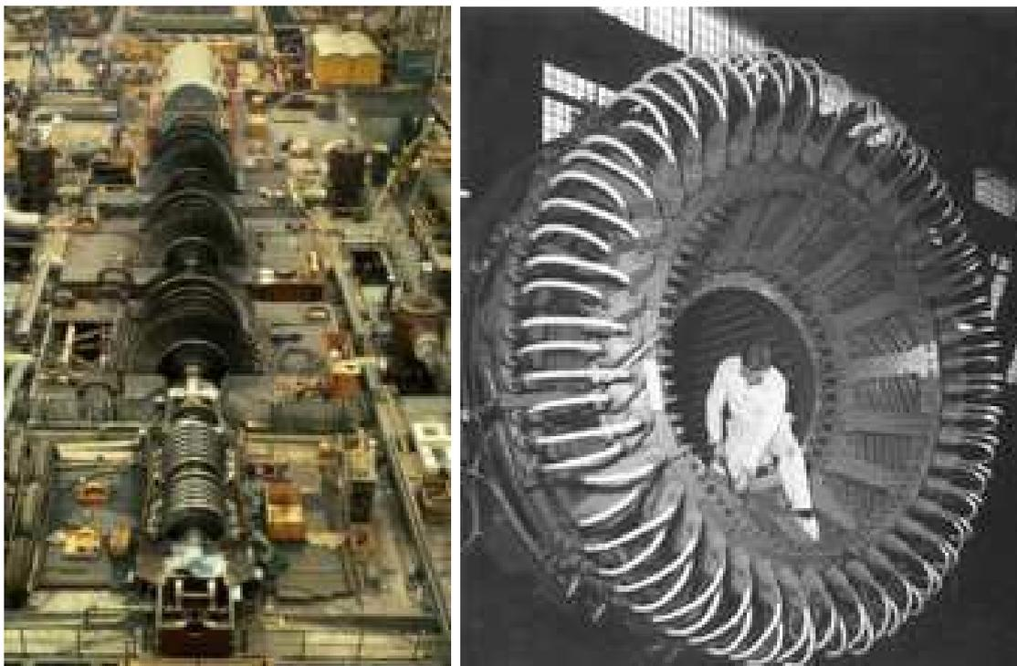
**FIGURE 1 – Gauche :** Partie tournante d'un turbo-alternateur. Au premier plan, les turbines haute pression puis les turbines basse pression. L'alternateur est en bout d'arbre, fermé. (Crédit : EDF SA) **Droite :** Extrémité statorique d'un turbo-alternateur, les développantes sont visibles sous la structure de serrage, la connexion avec le circuit de refroidissement est en blanc. (Crédit : SIEMENS AG)
