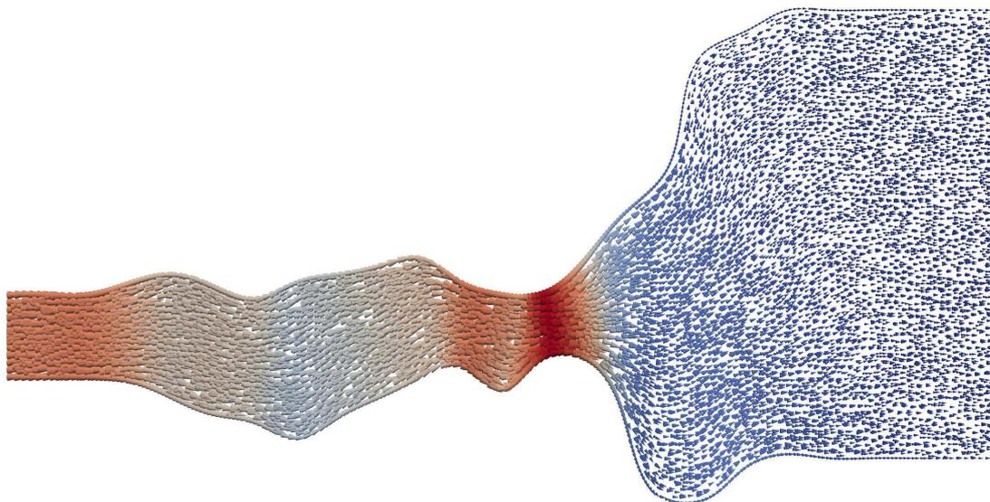
**FIGURE 1.12** – *Coupe de la densité de courant finale construite par l'algorithme d'optimisation.*
