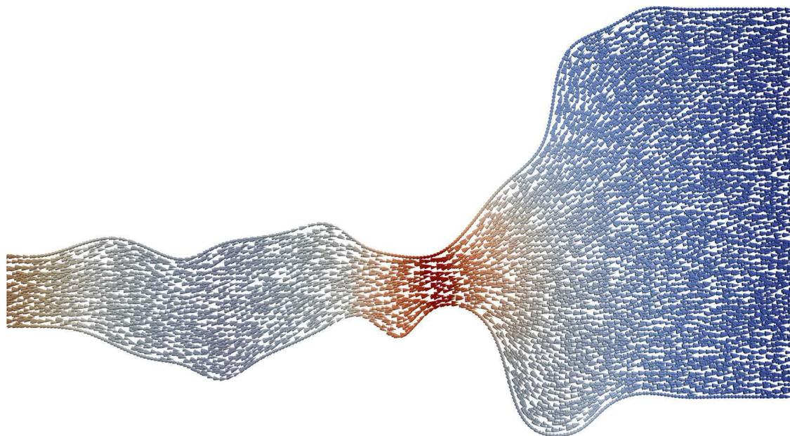
**FIGURE 1.7** – Coupe de la densité de courant dans l'inducteur après correction de la norme par la méthode des isopotentiels.
