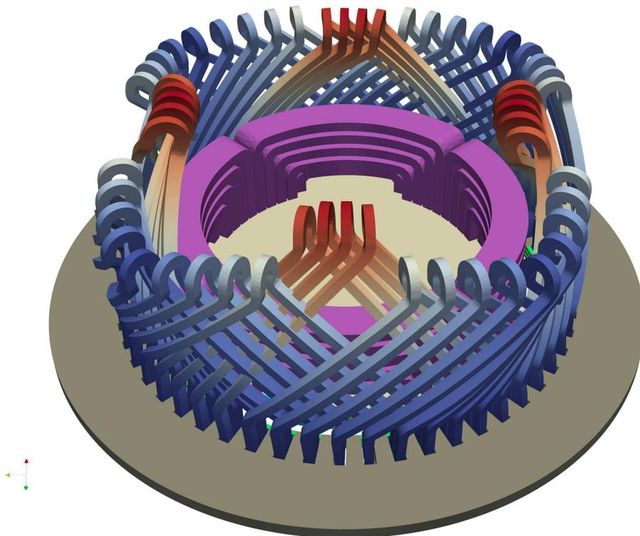
**FIGURE 1.31** – Tracé des déplacements des développantes à l'issu du calcul de mécanique. Pour ce cas, le mode 4 est prépondérant.
