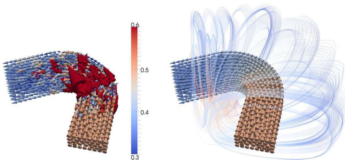
FIGURE 2.10 – Application aux coudes supérieurs de développantes. **Gauche** : Méthode d'arbre (Norme maximale tronquée). **Droite** : Méthode de minimisation (plus lignes de champs du calcul magnétique ayant parfaitement convergé).
