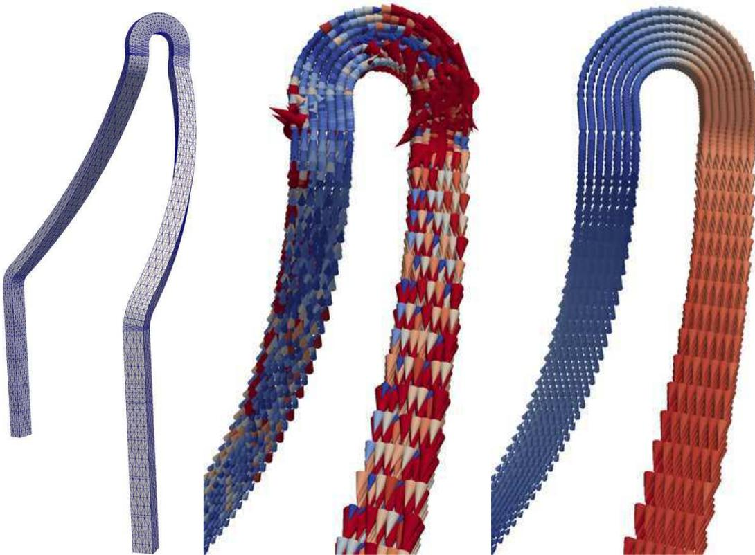
**FIGURE 3.4** – *Gauche* : géométrie d'une développante. *Milieu* : résultat produit pour l'annulation de la divergence à l'aide d'une méthode d'arbre. *Droite* : résultat obtenu avec la méthode de minimisation.
