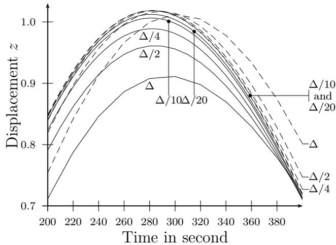
**FIGURE 1.18** – Zoom sur le premier maximum du déplacement. Les lignes en tirets représentent les valeurs obtenues avec la boucle pour les différents pas de temps. En traits plein, résultats sans la boucle. L'axe horizontal est donné en temps réduit.  $\Delta$  est choisi pour avoir au moins 30 points par pseudo-période.
