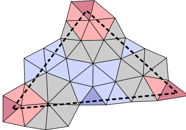
**FIGURE 3.3** – Représentation de la méthode par avance frontale sur un cas 2D : les différents niveaux d'éléments testés sont repérés par couleurs. L'algorithme teste en premier les éléments rouge foncé, puis par ordre les éléments rouge clair, gris, bleu clair et enfin bleu foncé.
