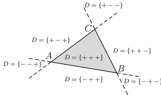
**FIGURE 3.1** –  $D$  représente le signe des trois déterminants issus de deux faces du triangle  $ABC$  et du point local  $P$  :  $D = \{sign[ABP], sign[ACP], sign[BCP]\}$ . Si tous les déterminants sont positifs, alors le point  $P$  appartient au triangle.
