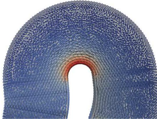
**FIGURE 1.4** – Exemple de densité de courant source calculée par la méthode électrocinétique.
