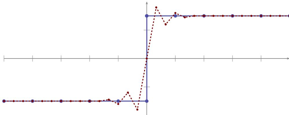
**FIGURE F.1** – *Exemple unidimensionnel d'oscillations.* La fonction source en bleu est discrétisée sur les intervalles  $n, n = -5 \dots 5$  et la fonction cible est discrétisée par intervalles  $n/3, n = -15 \dots 15$ .
