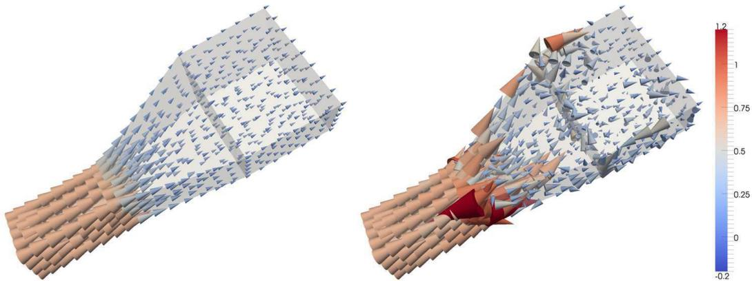
**FIGURE 2.6** – *Résultat après annulation de la divergence pour le second cas test : sur les faces du co-arbre, la densité est fortement modifiée par accumulation des erreurs. **Gauche** : Densité de courant source. **Droite** : Champ après correction par la méthode d'arbre.*
