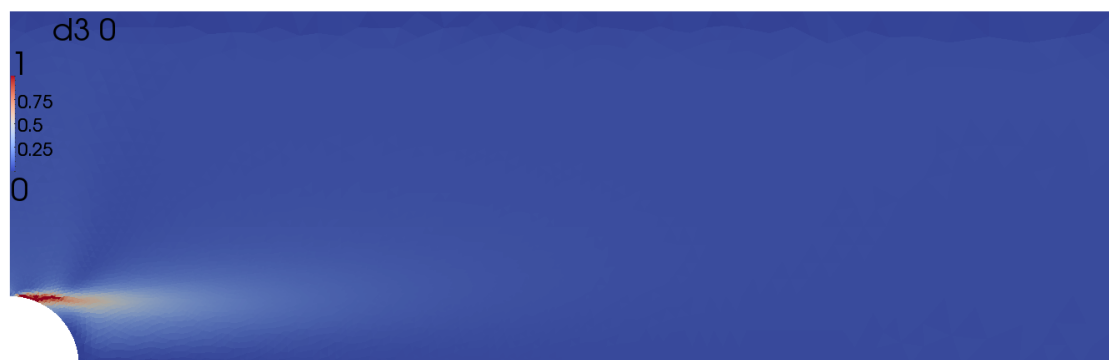
FIGURE 6.5 – Cartographie de la variable d'endommagement d dans le pli supérieur orienté à 0^\circ pour \varepsilon_c
