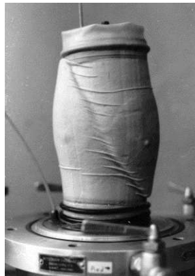
FIGURE 3.1 – Bande de cisaillement dans un sable lors d'un essai triaxial - [Colliat-Dangus, 1986] d'après [Desrues et Chambon, 2002]
