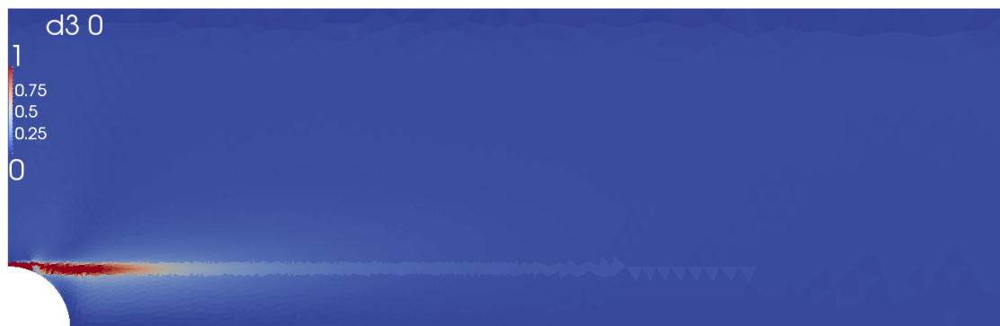
FIGURE 6.27 – Cartographie de la variable d'endommagement d dans le pli supérieur orienté à 0^\circ pour \varepsilon_c - \tau_c = 0.02 s - \tilde{Y}_c = 3.3 MPa
