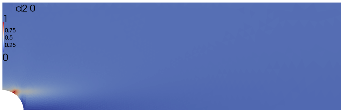
FIGURE 6.7 – Cartographie de la variable d'endommagement d' dans le pli central orienté à 90^\circ pour \epsilon_c
